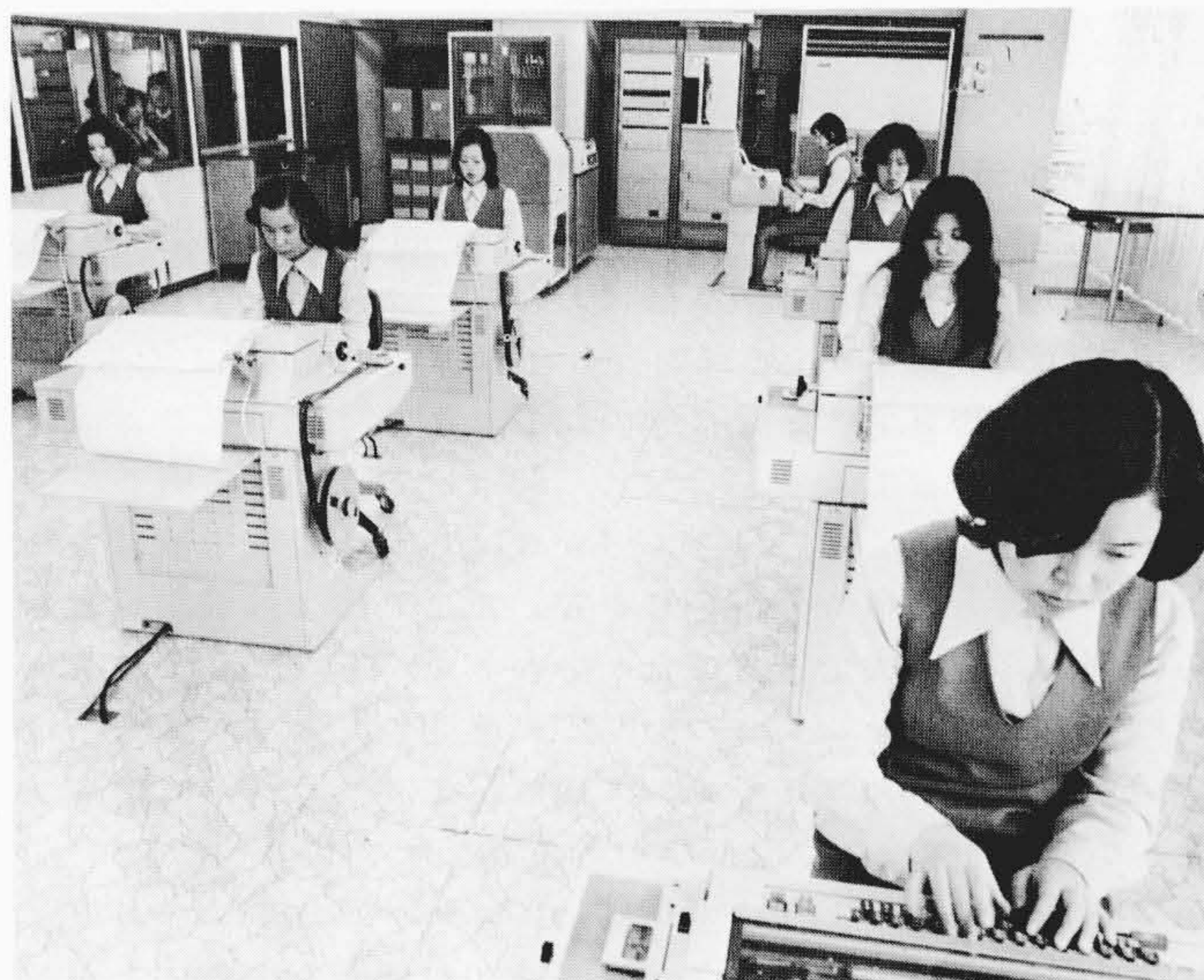
図1 HITAC 10IIマルチ ビリング システムの一例 HITAC 10II及び磁気テープが正面奥に見える2個のラックに収納されており、他にディスク、ライン プリンタをもち、タイプライタは10台を同時制御している。
