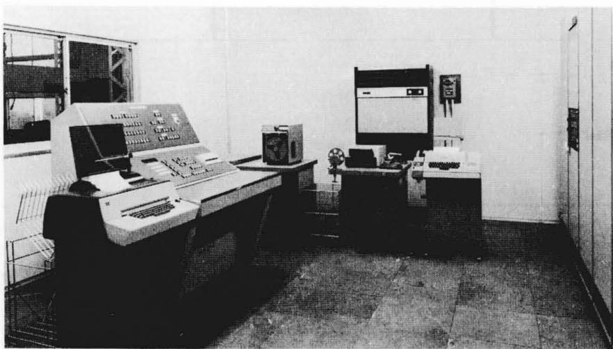
図11 IMS 計算機室概観 右方がHIDIC 350計算機システムで、左方のオペレーターズ コンソール越しにシャフト加工ラインが見渡せる。
