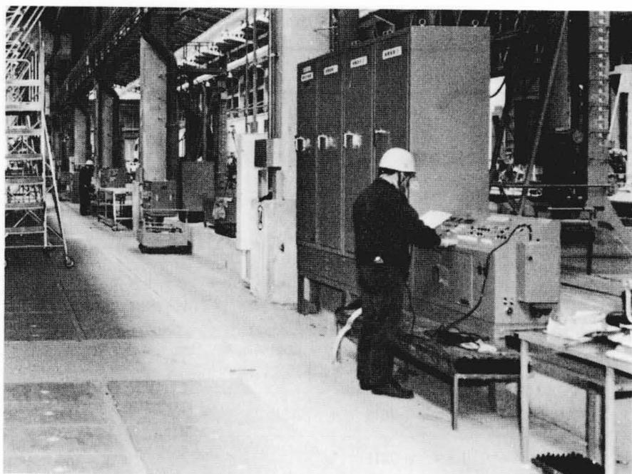
図7 試験現場端末機器 1ステーション分の電気試験機及び継電器箱、固定操作盤を示す。固定操作盤では初期試験条件を設定中である。
