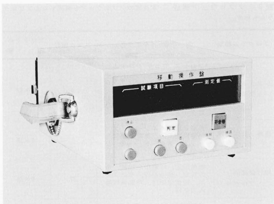
図6 移動操作盤 試験を行なうとき、車両の床下や出入台にある配電盤の間を自由に持ち歩けるよう極力小形軽量化を図った。概略寸法は、幅210×高さ120×奥行250(mm)であり、重量は約3.5kgである。
