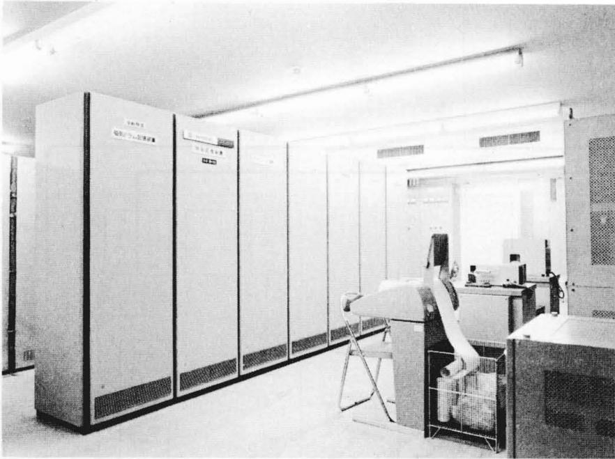
図3 中央機器室 中央機器室機器は、本図に示す以外に隣室に設置した中央操作盤、ロギングタイプライタから成る。中央機器室は、通常は無人である。
