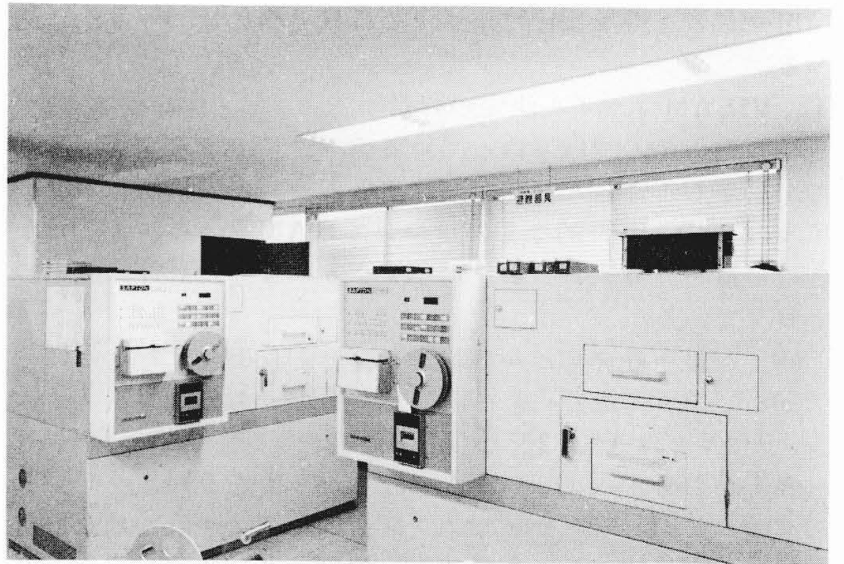
図8 全自動写真植字機〔(SAPTON) 株式会社写研製〕 カセット磁気テープを入力として、時刻表の版下を連続的に作成する。
