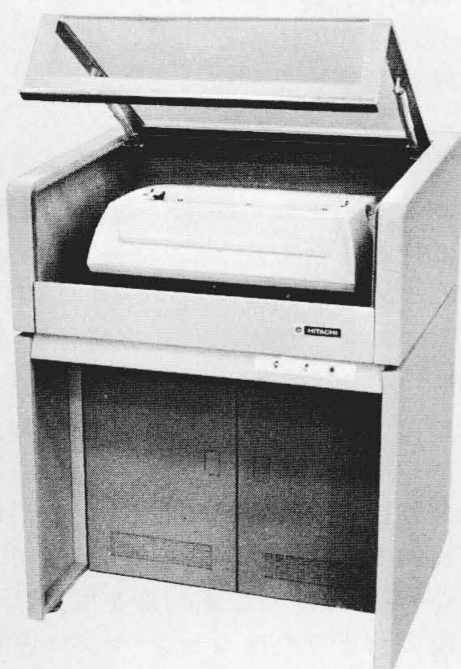
図1 H-7864C形プリンタ 大幅な電子化が進められた高速(30字/秒)プリンタで、防塵カバー付きのデスクに収納されている。
