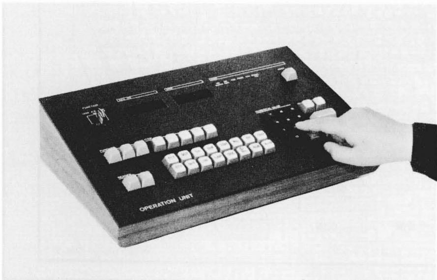
図7 716形用項目選択制御装置オペレーションユニット
