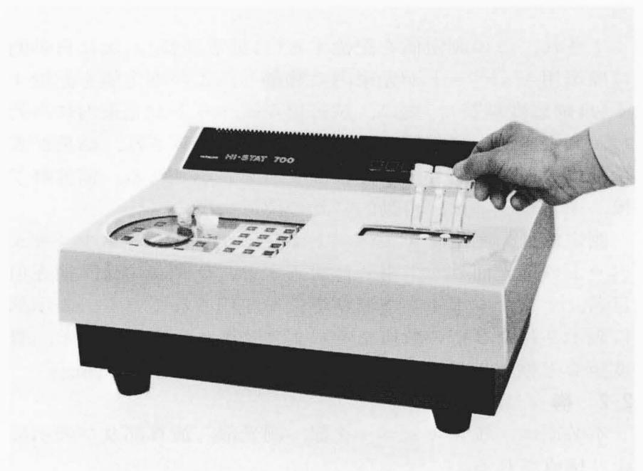
図1 血液検査装置「ハイスタット700」 二波長分光測光によるKineticsモード、End Pointモードによる高性能血液検査装置である。操作性を向上させるため、操作つまみやスイッチを廃した。
