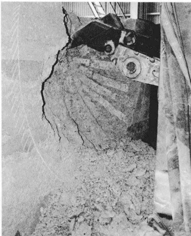
図9 コンクリート掘削実験 圧縮強度100kg/cm<sup>2</sup>級の軟岩掘進の可能なことが確認された。
