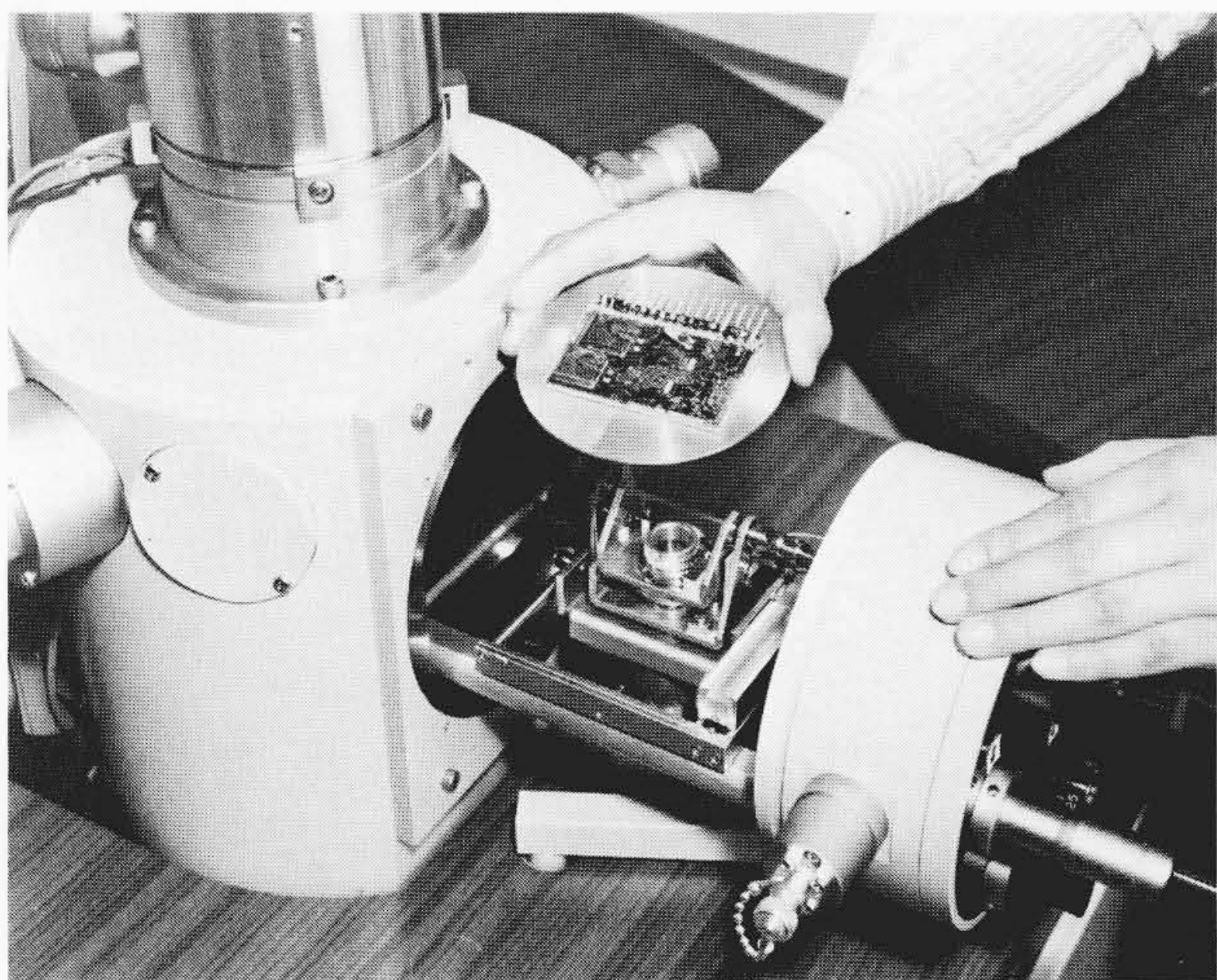
図3 走査形電子顕微鏡S-450形での大形試料の装着
