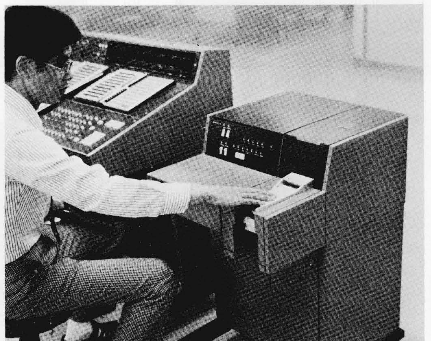
図1 自動取消装置の外観 指定券挿入口は、装置前面の右の部分に位置している。
