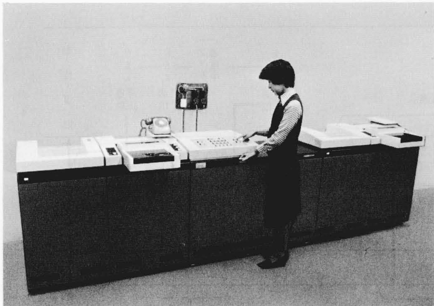
図5 本省で稼働中のHIMACI010形回線網接続装置及びHF932X形ファクシミリ装置 操作中の装置が回線網接続装置で、右端の装置が西ルート向けファクシミリ装置、左端の装置が東ルート向けファクシミリ装置である。
