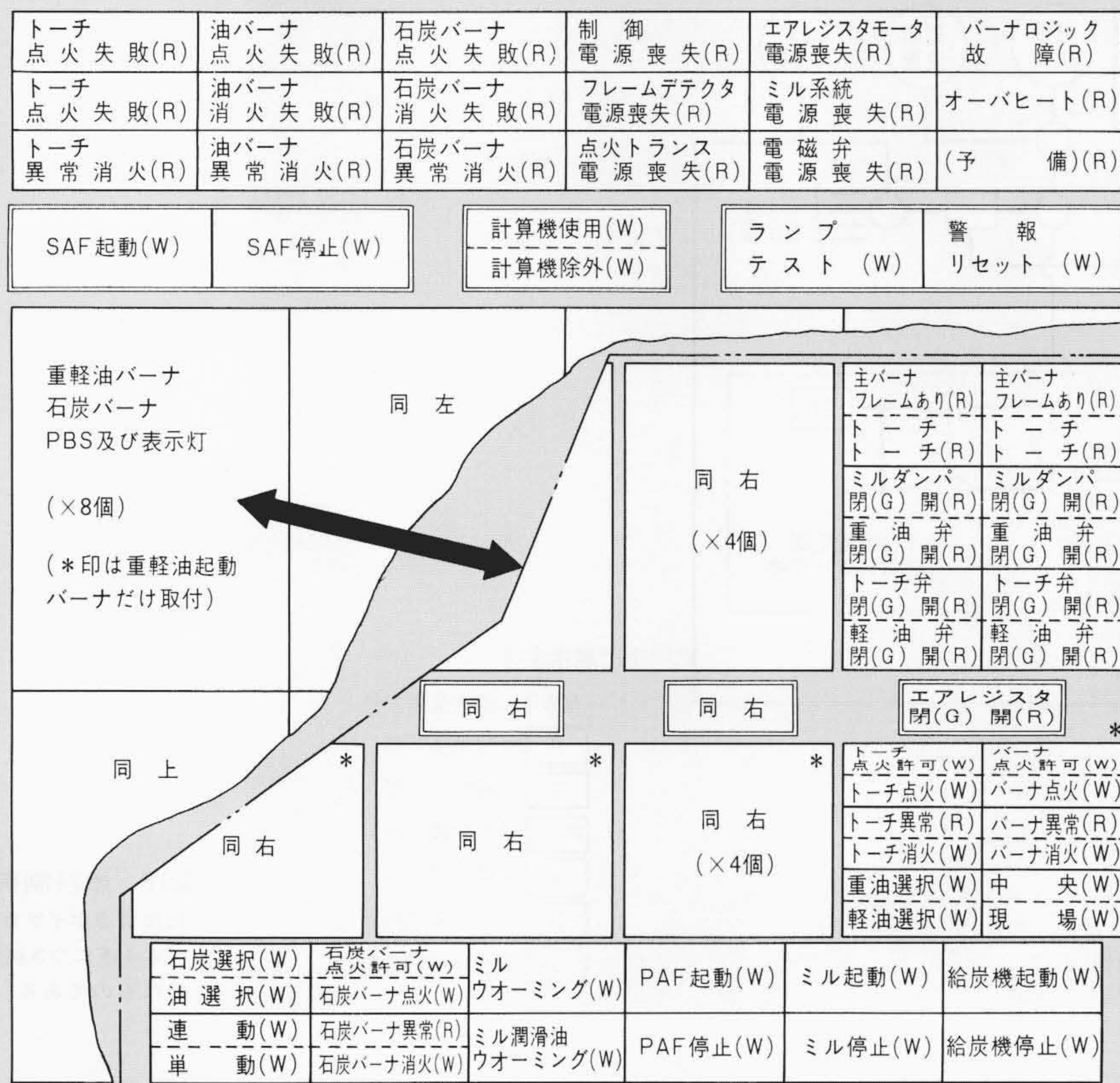
図6 自動バーナオペレーターズコンソール 重軽油・石炭バーナの点火・消火操作及び異常表示などの押しボタン表示灯を取り付けている。
