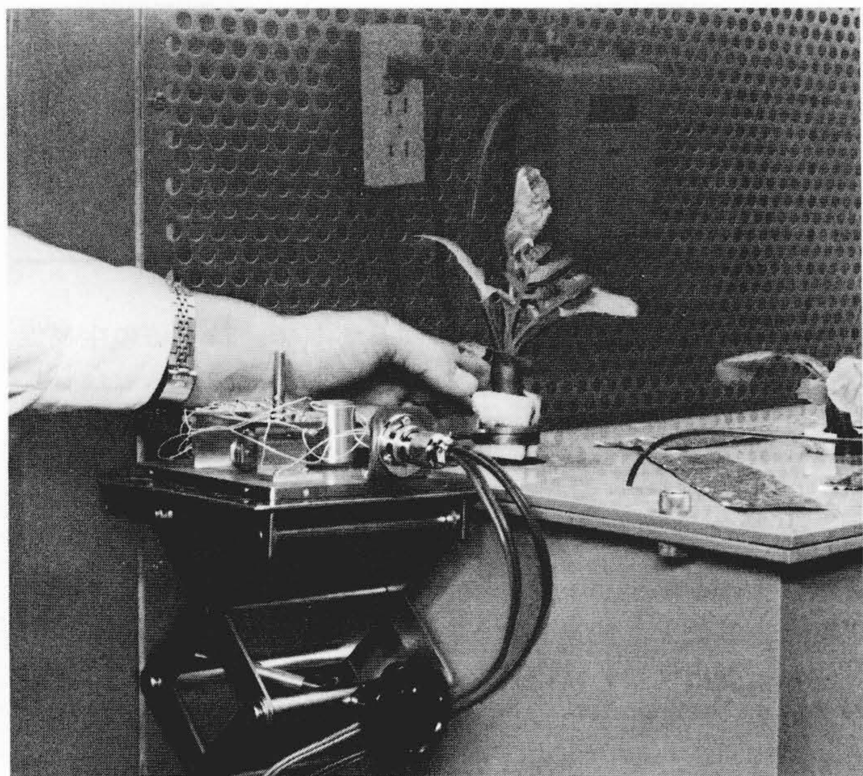
図15 植物の重量連続測定装置 試料に二十日大根を用いている状況を示す。
