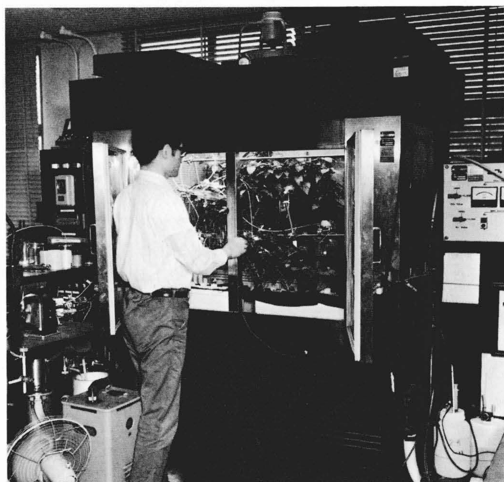
図4 グロースチェンバ 試料としてピーマンを用いている。左下は質量分析計を、右端は炭酸ガス濃度コントローラを示す。
