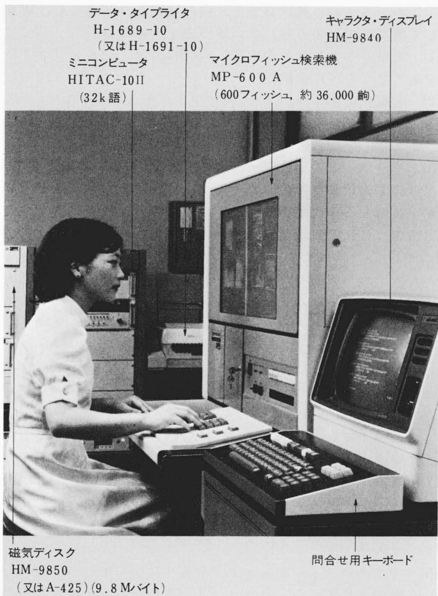
図3 会話型マイクロフィッシュ情報検索システムの機器構成例(外観) 人間からシステムへの問合せは、「問合せ用キーボード」を通じて行ない、システムから人間への応答は、「キャラクタ・ディスプレイ」及び「マイクロフィッシュ検索機」を通じて行なわれる。
