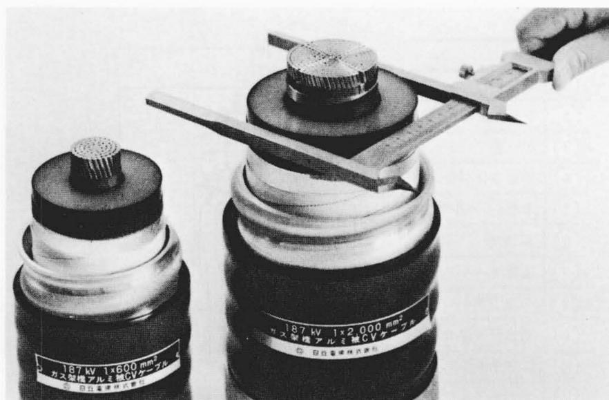
図3 187kV 1×2,000mm<sup>2</sup> (右)及び 1×600mm<sup>2</sup> (左)アルミ被 CV ケーブル 2,000mm<sup>2</sup> ケーブルの外径は 136mm で、275~500kV OF ケーブルの外径に相当する。
