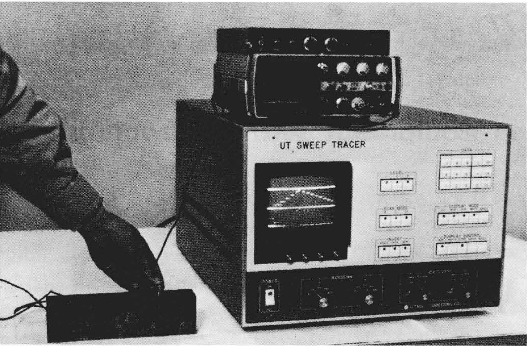
図2 装置の外観 鋼材内部のドリル穴を探傷している状況を示す。超音波探傷器には反射波のパルス波形、画像処理部には断面像が表示されている。
