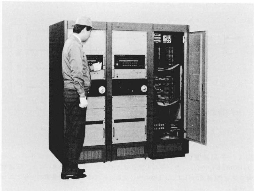
図6 HITAC 10II/Lを使用した部分的二重化システム外観 ミニコンピュータ2台による二重形とせず、一方をマイクロコンピュータに代えた支援形の例もある。
