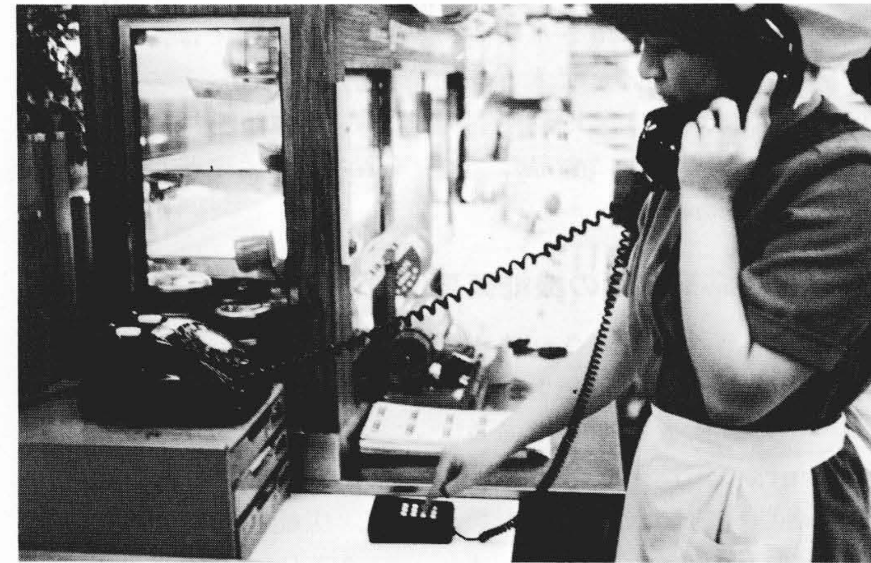
図3 プッシュボタン・アタッチメントの外観 販売店から回転ダイヤル式電話機(左側)と、プッシュボタン・アタッチメント(中央)により注文データを入力する。
