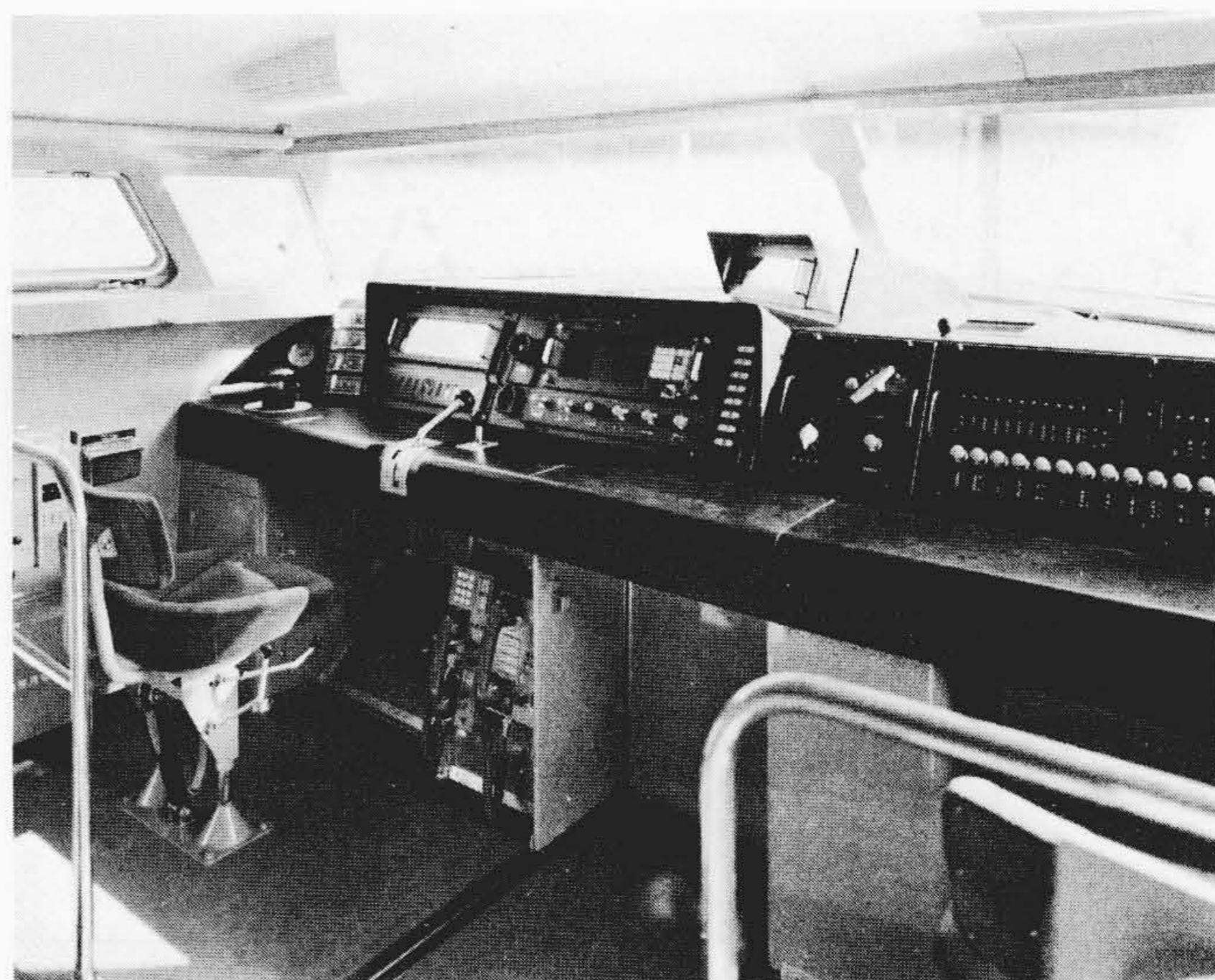
図9 運転台 計器板をトレイ構造にまとめて着脱を容易にし、保守及び製作の便を図っている。
