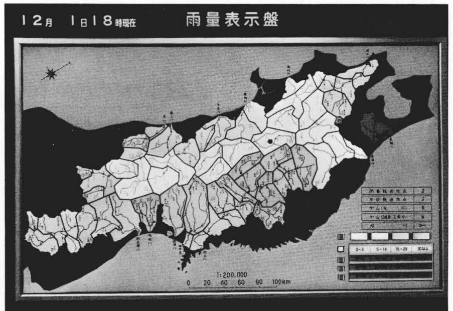
図13 雨量表示盤の表示例 東北地方全体の区間流域平均時間雨量の表示した例を示す。右下の押しボタンで1時間、3時間、6時間、累加雨量表示を切り換える。
