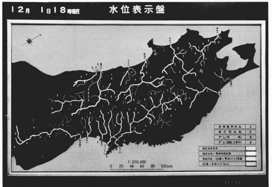
図12 水位表示盤の表示例 東北地方全体の1級河川の水位状況を表示した例を示す。
