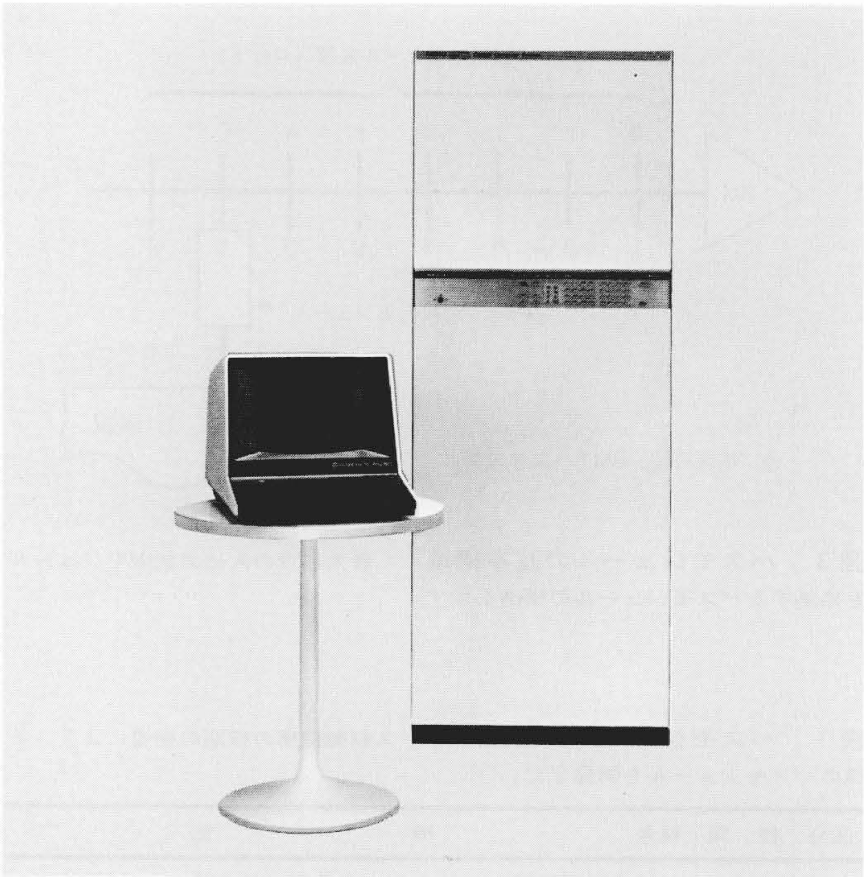
図4 HIDIC 80-E 処理装置 I 筐体に主メモリ512k語と入出力バスを実装できる。
