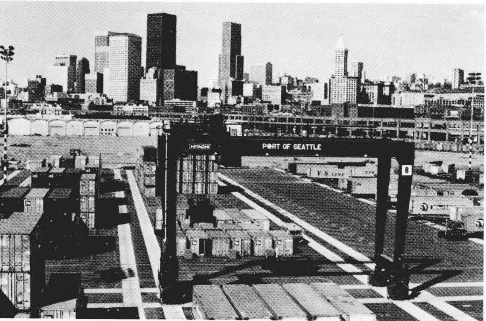
図3 完成した日立ラバータイヤ式トランスファークレーン(POSターミナルでは全部で6台使用) 同仕様のものがこのターミナルでは、6台使用されている。
