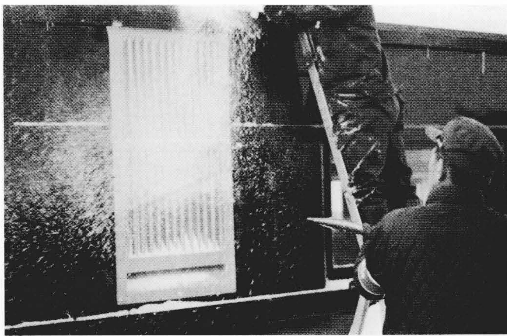
図8 現車の定置試験状況 空気取入れグリル前面での人工降雪状況を示す。
