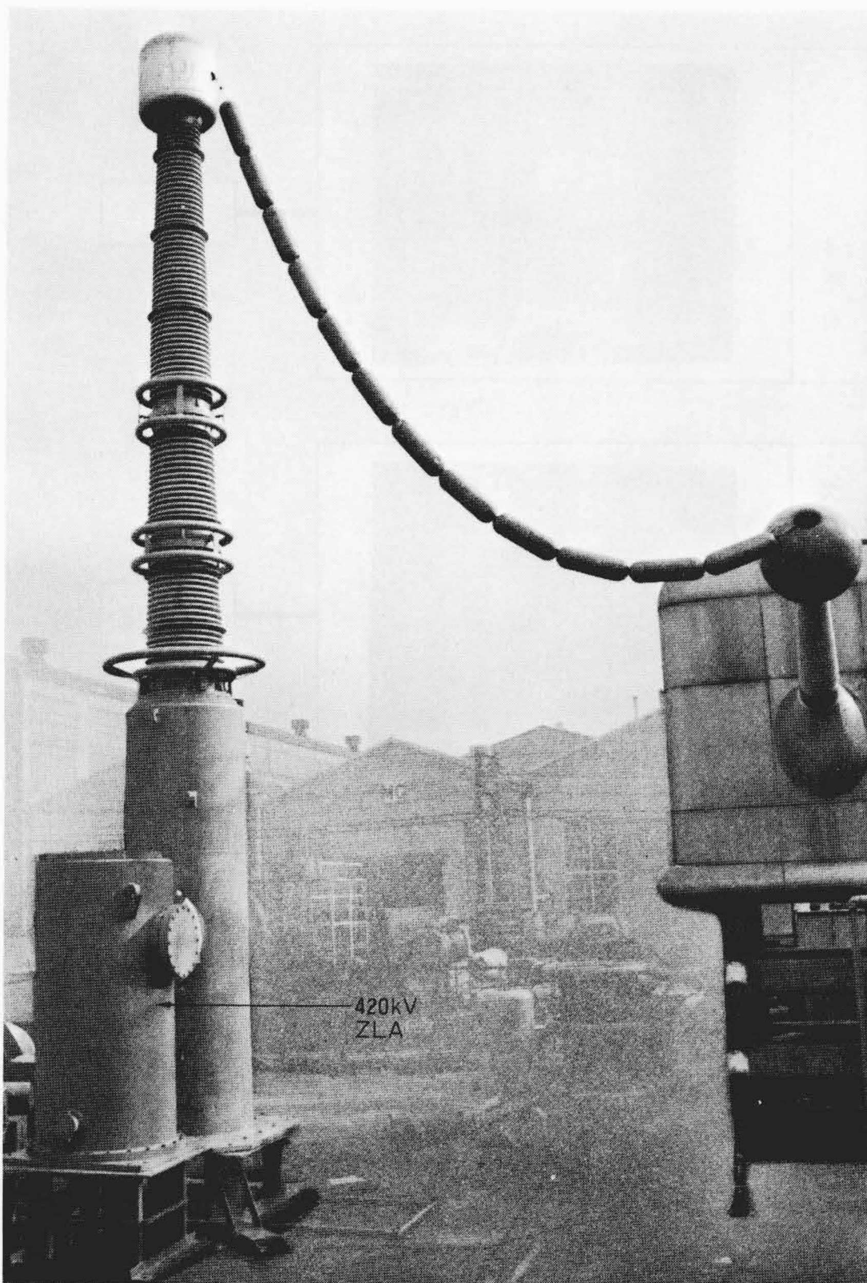
図8 ガス絶縁開閉装置用420kV ZLA 420kV ZLAの工場内での課電試験状況を示す。
