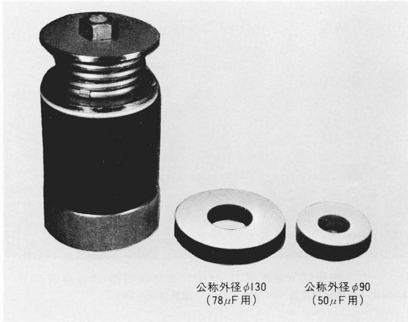
図3 Z元素の形状及び組立構造 ドーナツ形素子の開発により、素子の放電耐量を上げるとともに焼成密度の均一化を図っている。組立構造はZ元素の内径側に絶縁棒を配置し、これをガイドとしてZ元素を積み重ねている。
