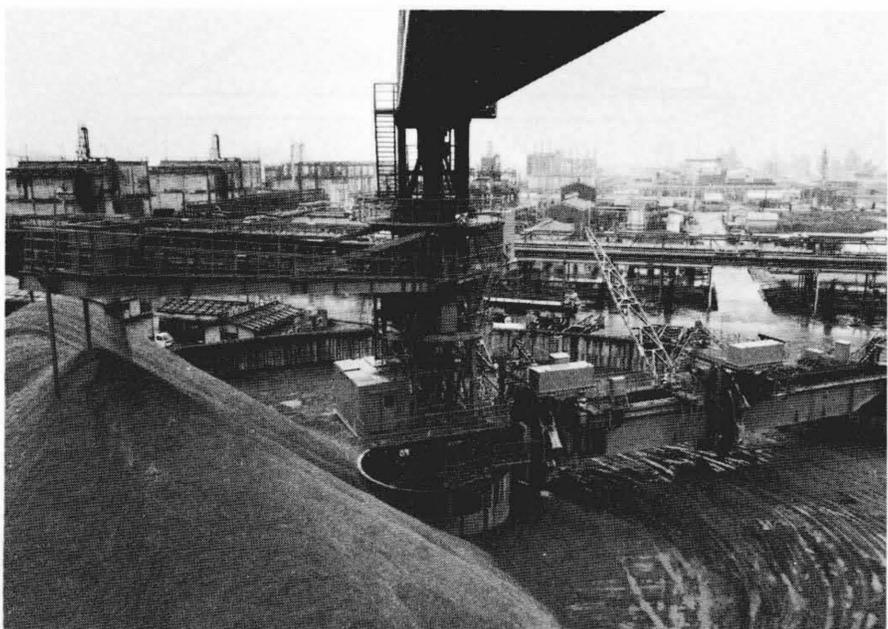
図10 橋形リクレーマ 橋形リクレーマの採用により，自動化及びブレンディングが容易となった。
