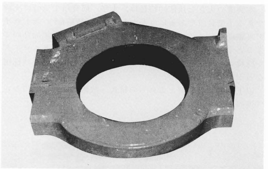
図3 トロイダル磁場コイルの外観 完成したトロイダル磁場コイル1個の外観を示す。電磁力を支持するための非磁性ステンレス鋼製のサポートを設けている。
