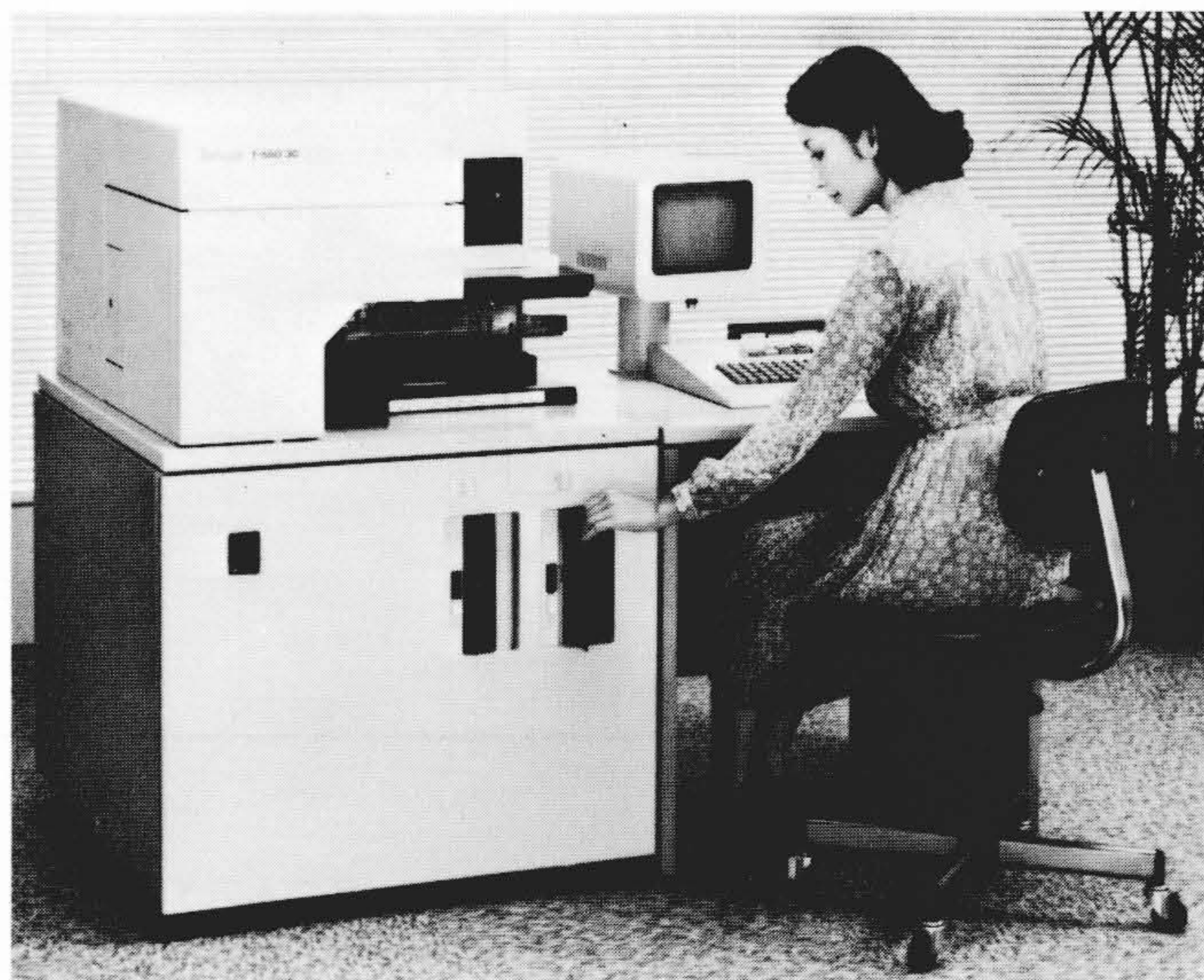
図4 HITAC T-550/30分散形OCRシステムの外観 左側半分が紙送り、スタッカを含むOCR部であり、手で持っている箇所がフロッピーディスクである。また、右側はディスプレイと操作部である。
