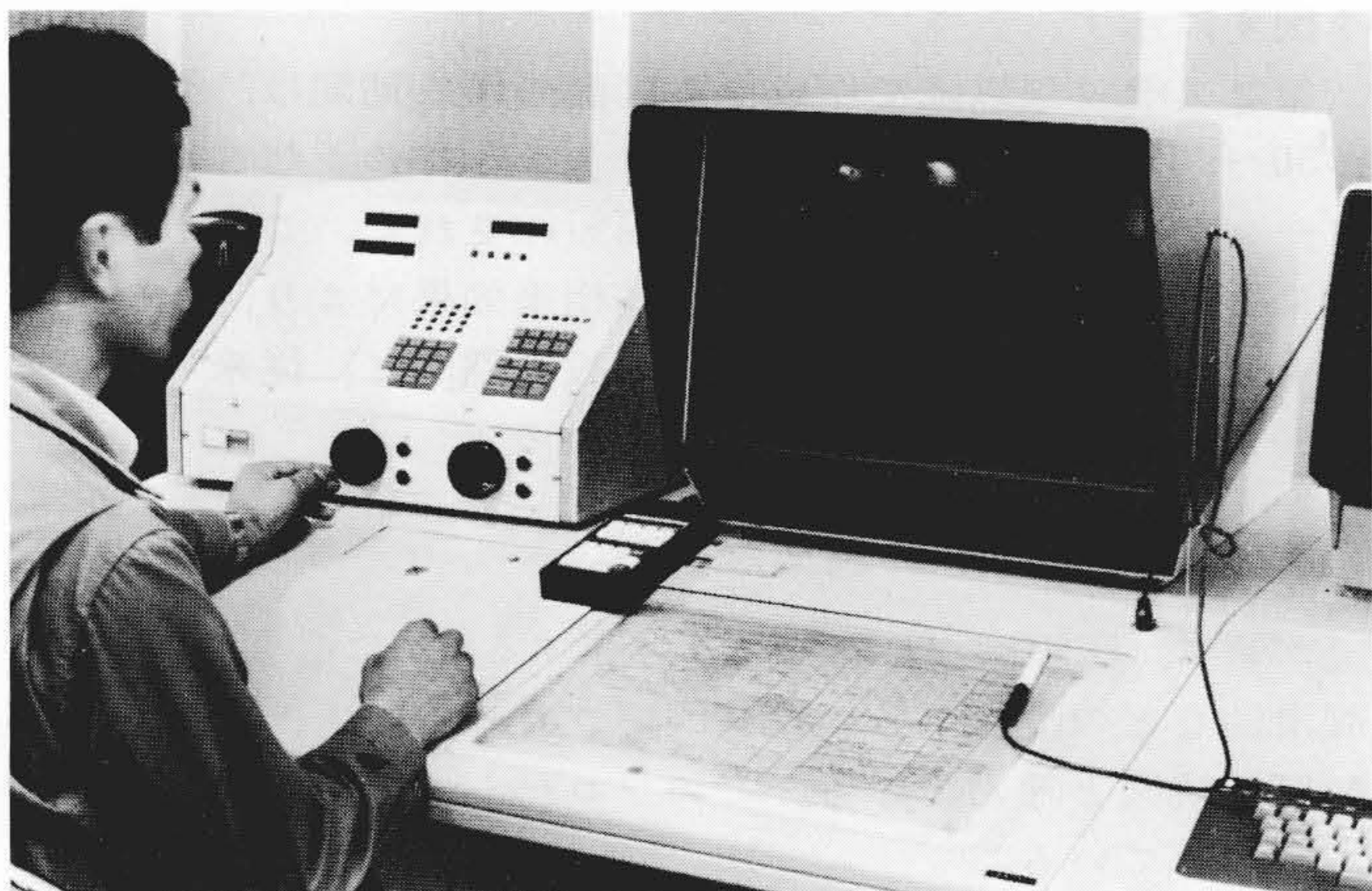
図6 手動装置 ハンドクランク機構が工作機械とよく似ているので、あたかも切削するかのようにして、NC情報を登録することができる。
