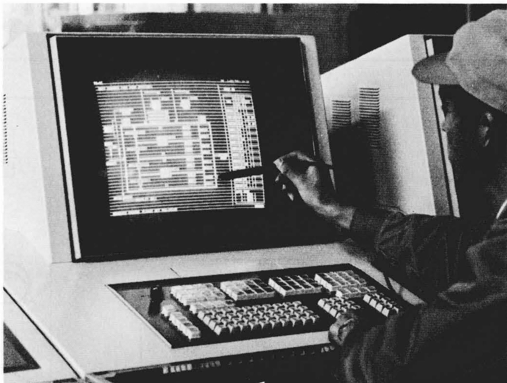
図6 ライトペンによる機器発停操作 CRT画面に表示されているプロセスの機器をライトペンにより直接、起動及び停止操作を可能とし、かつ操作手順はガイダンスされる。
