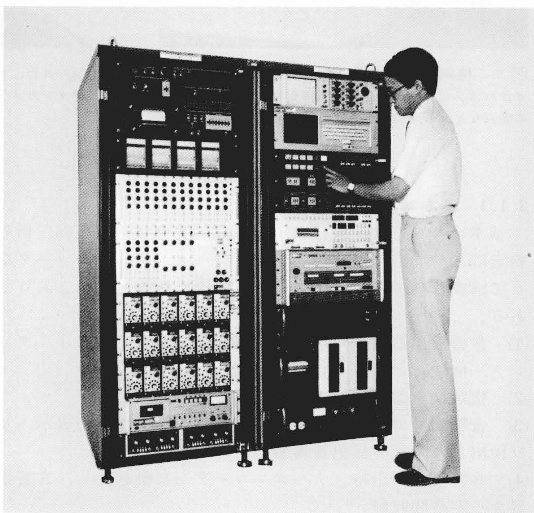
図5 音響振動監視装置の外観 本体だけの外観を示すもので、左が基本ユニット、右が分析ユニットである。
