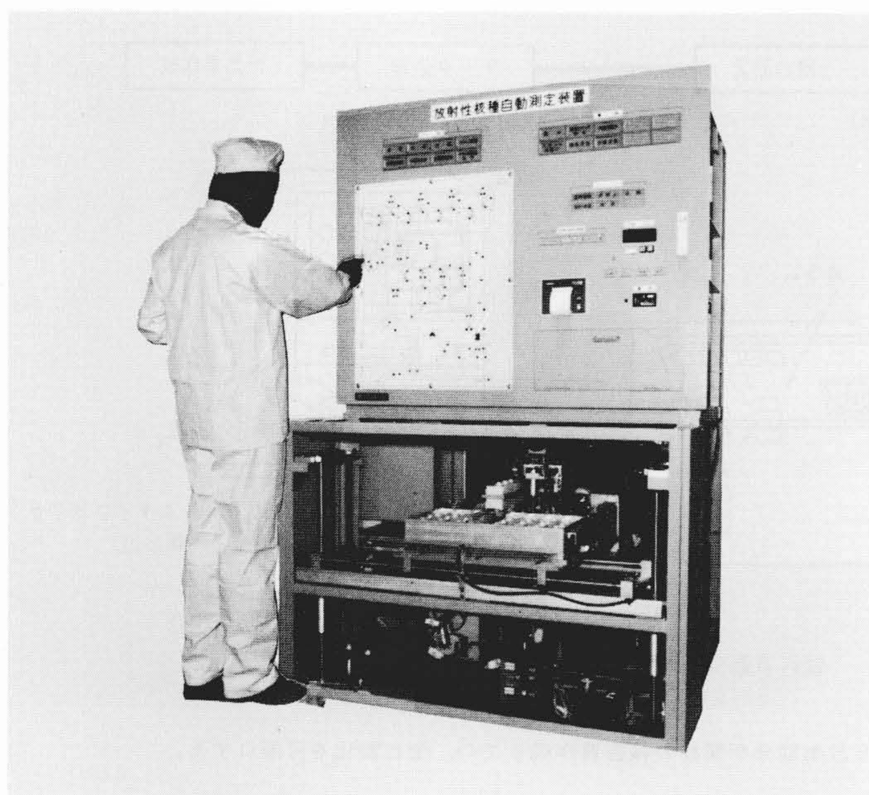
図2 試料水処理装置の外観 スタートスイッチを押す操作だけで、放射能測定試料のイオン交換樹脂カラムを作製する。スタート信号は容易に外部装置(一例として、燃料検査の SHIPPING 装置)と同期を取ることができる。
