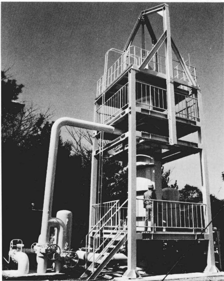
図5 高速増殖原型炉「もんじゅ」中間熱交換器水流動試験装置
