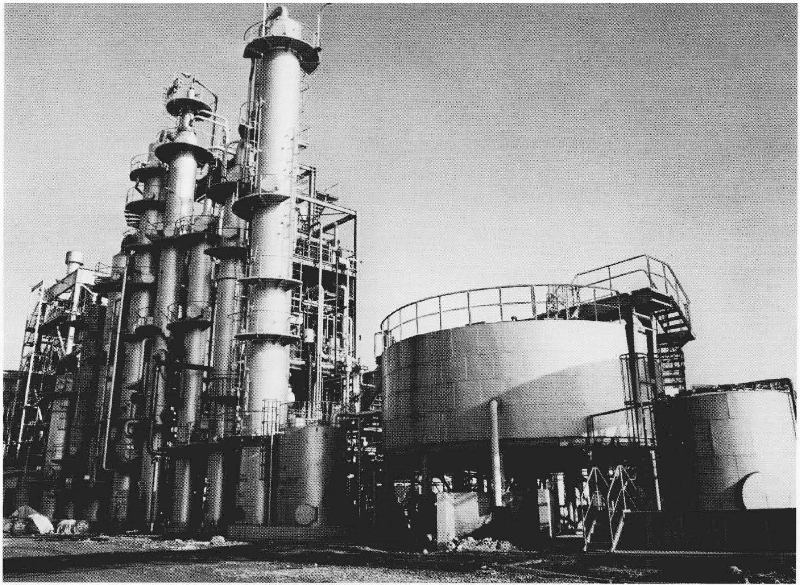
図34 紙・パルプ緑液からの硫黄分離装置
