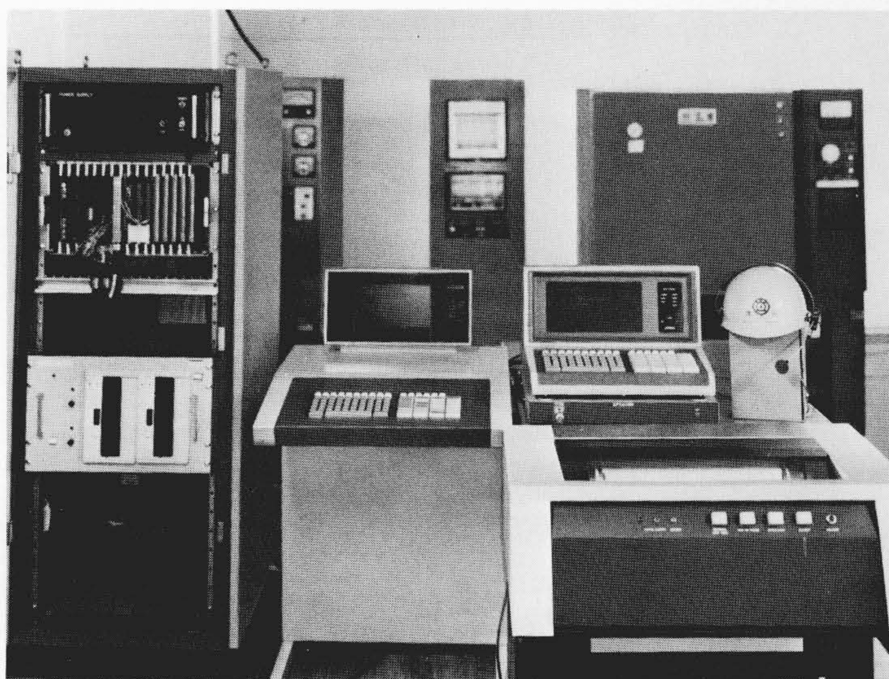
図24 自動倉庫の制御管理用マイクロコンピュータ
