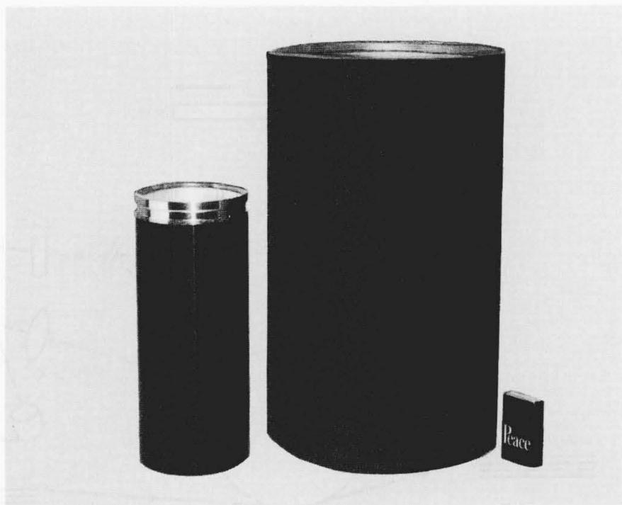
図7 長波長用有機光導電体を塗工したドラム 各々、直径260mm及び120mmである。
