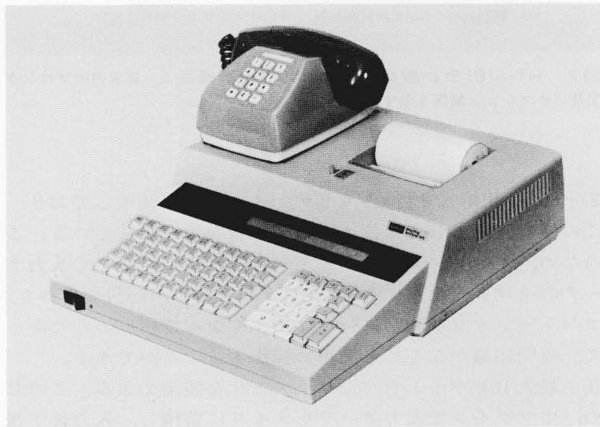
図1 HT-5101テレホンターミナルの外観 電話機を除いた大きさは、幅370×奥行450×高さ120(mm)である。
