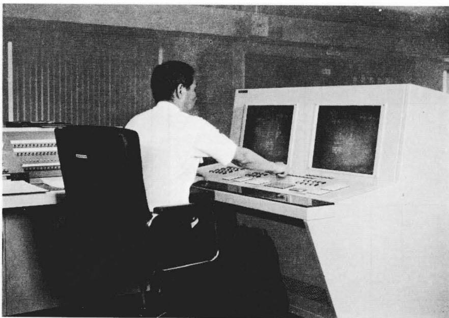
図5 運行管理操作盤 プロセスディスプレイ装置2台と操作盤から構成され、円滑なマンマシン機能を支援している。
