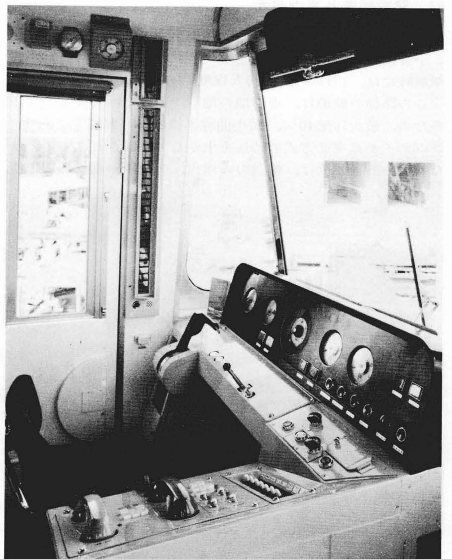
図4 乗員室 乗員室には、手動運転用主幹制御器ハンドルと自動運転用出発押しボタンスイッチが設けられている。
