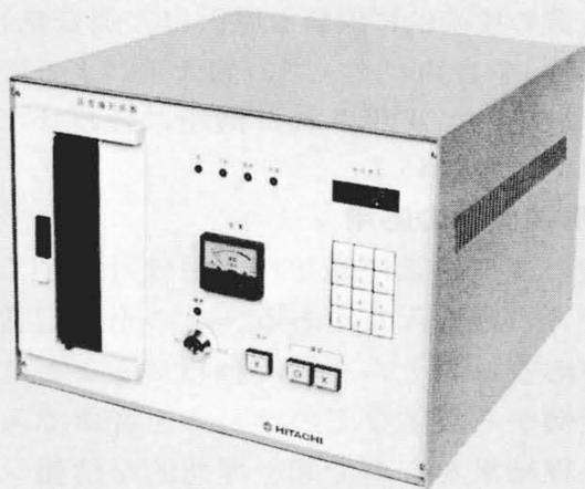
図3 話者認識装置の外観 HRS-10話者認識装置の外観を示す〔外形寸法: 幅430×奥行450×高さ300(mm)〕。
