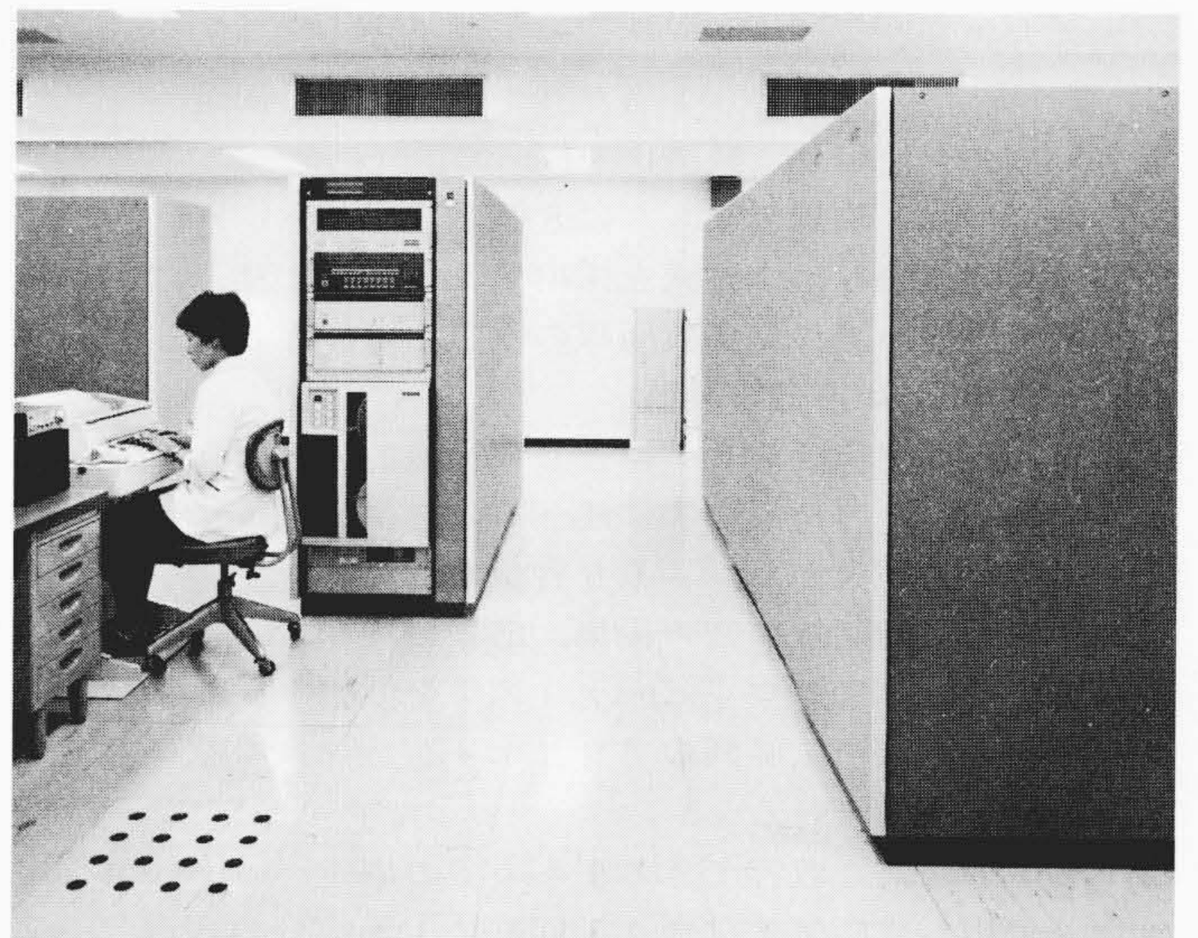
図4 H1200形音声応答装置の外観 H1300形, H1100形の外観は、H1200形と同様である。
