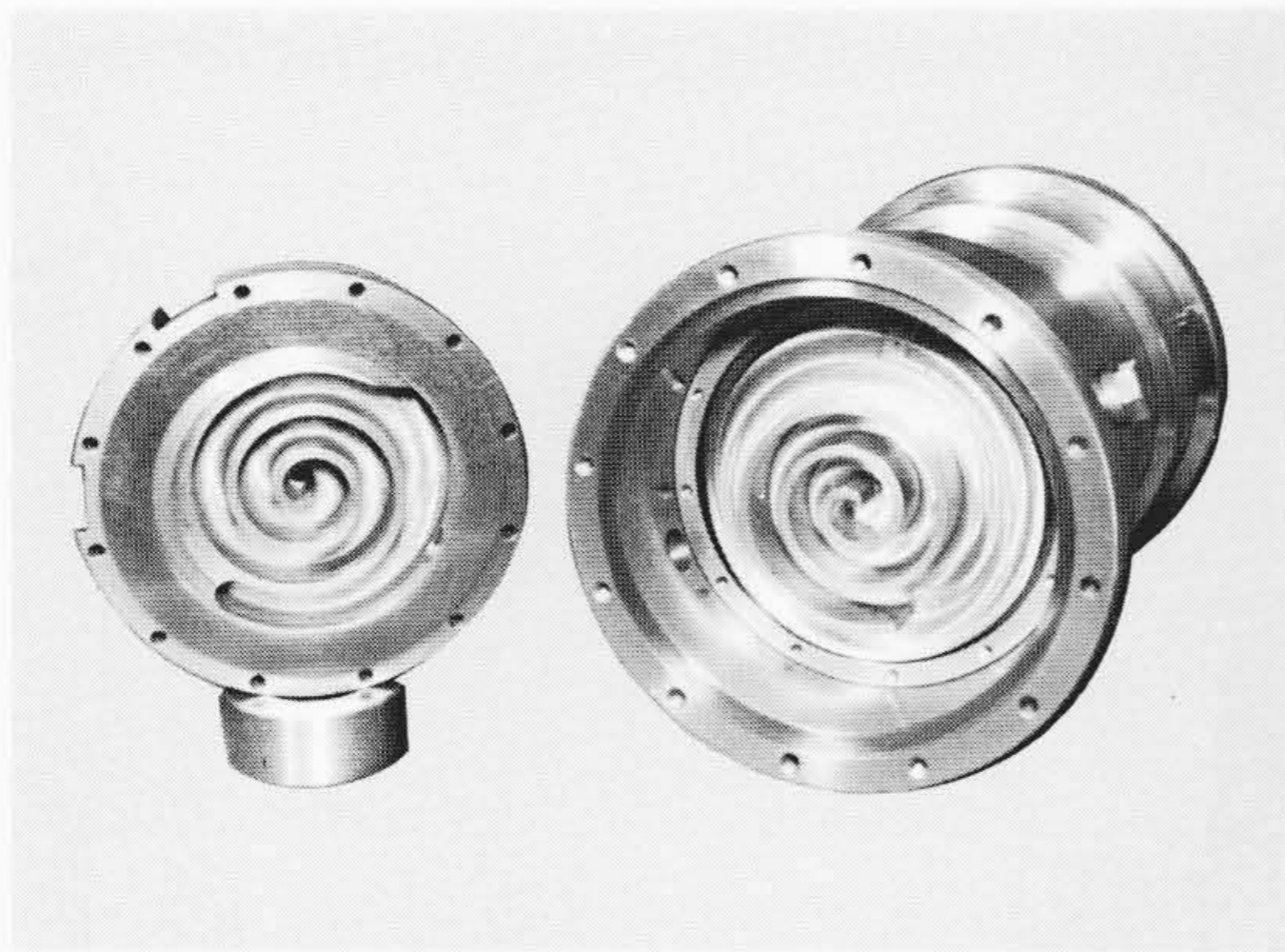
図9 2.2kW空調機用スクロール圧縮機(全密閉形実験機)
