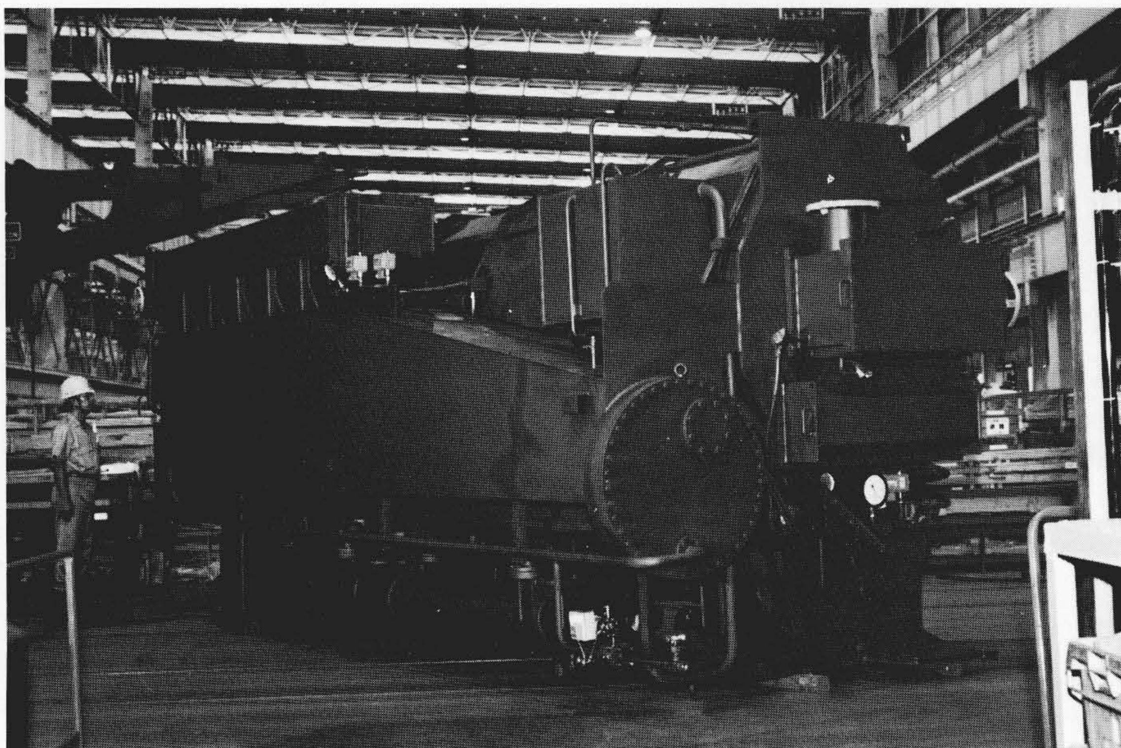
図27 高温度出力吸収式ヒートポンプ
