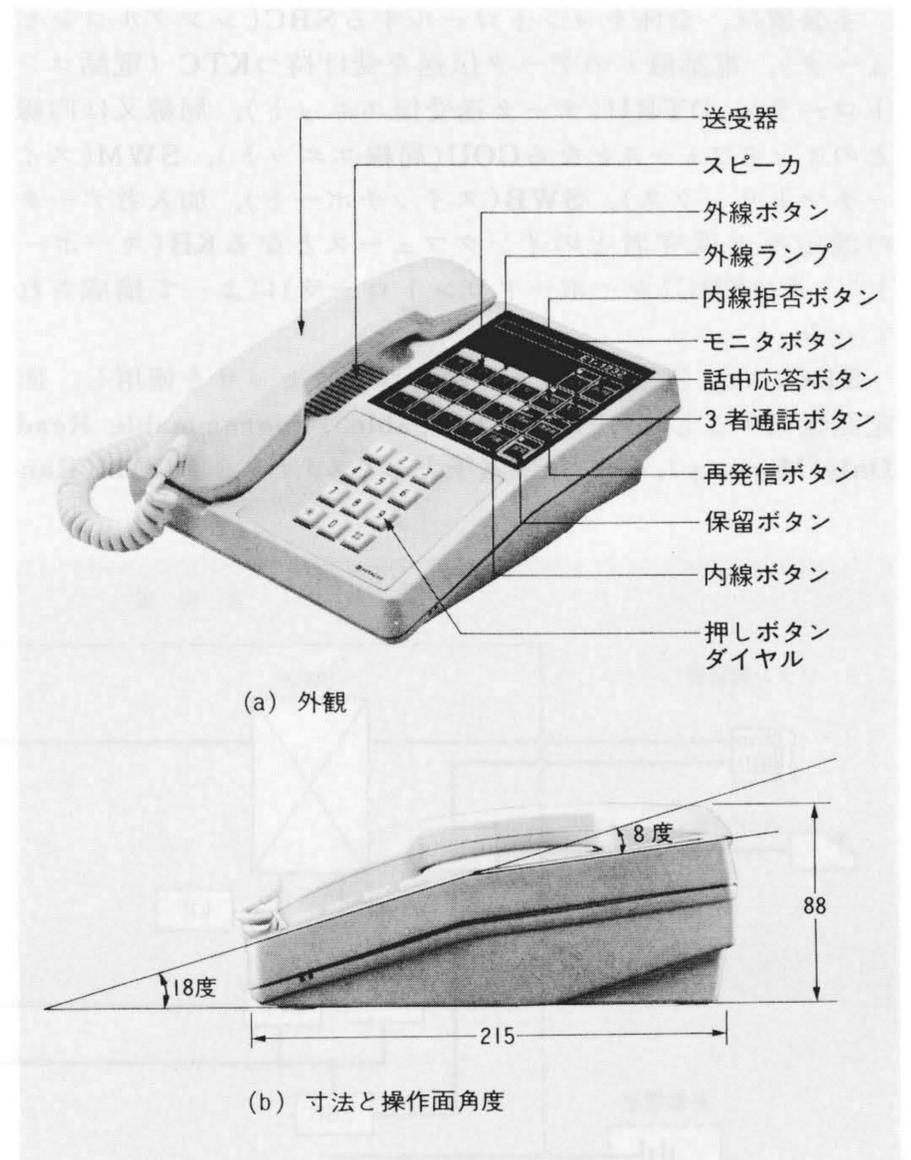
図1 電子ボタン電話機の外観 小形で薄く、シートキーボードを採用した斬新なデザインにまとめている(横幅200mm)。
