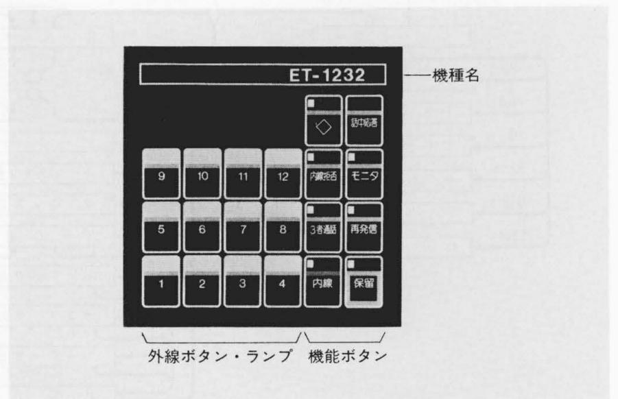
図4 「ETシリーズ」のシートキーボード例 配置は操作性を考慮して機能ブロックにまとめている。
