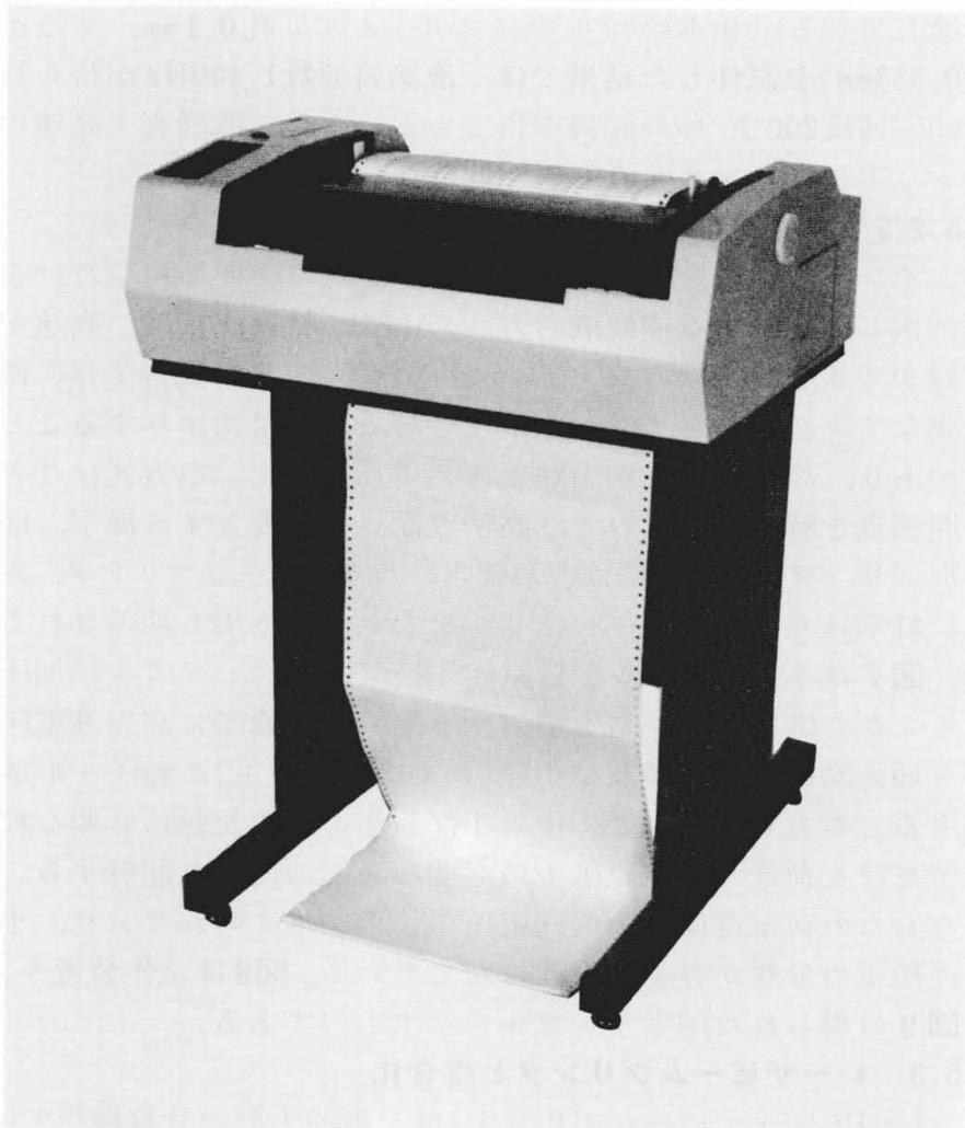
図8 試作マイクロドット インクジェット漢字プリンタ 記録速度100字/秒, 32×32ドット構成になっている。
