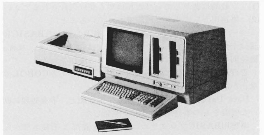
図2 Data Pal 20の外観 JIS配列キーボード、132桁プリンタを示す。
