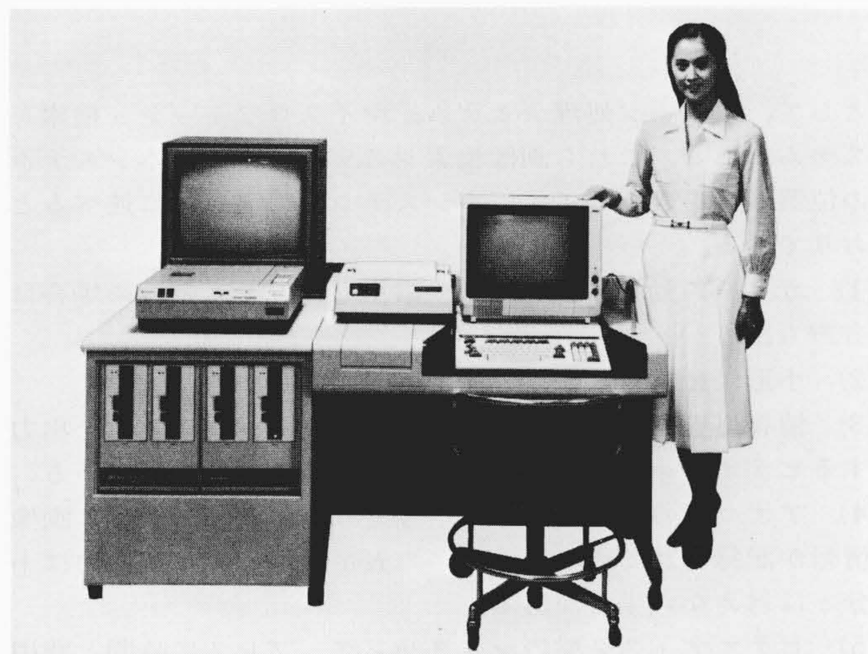
図1 システムの外観 写真右側にあるのがパーソナルコンピュータで、左側のモニタテレビジョンの前にあるのがビデオディスクプレーヤである。
