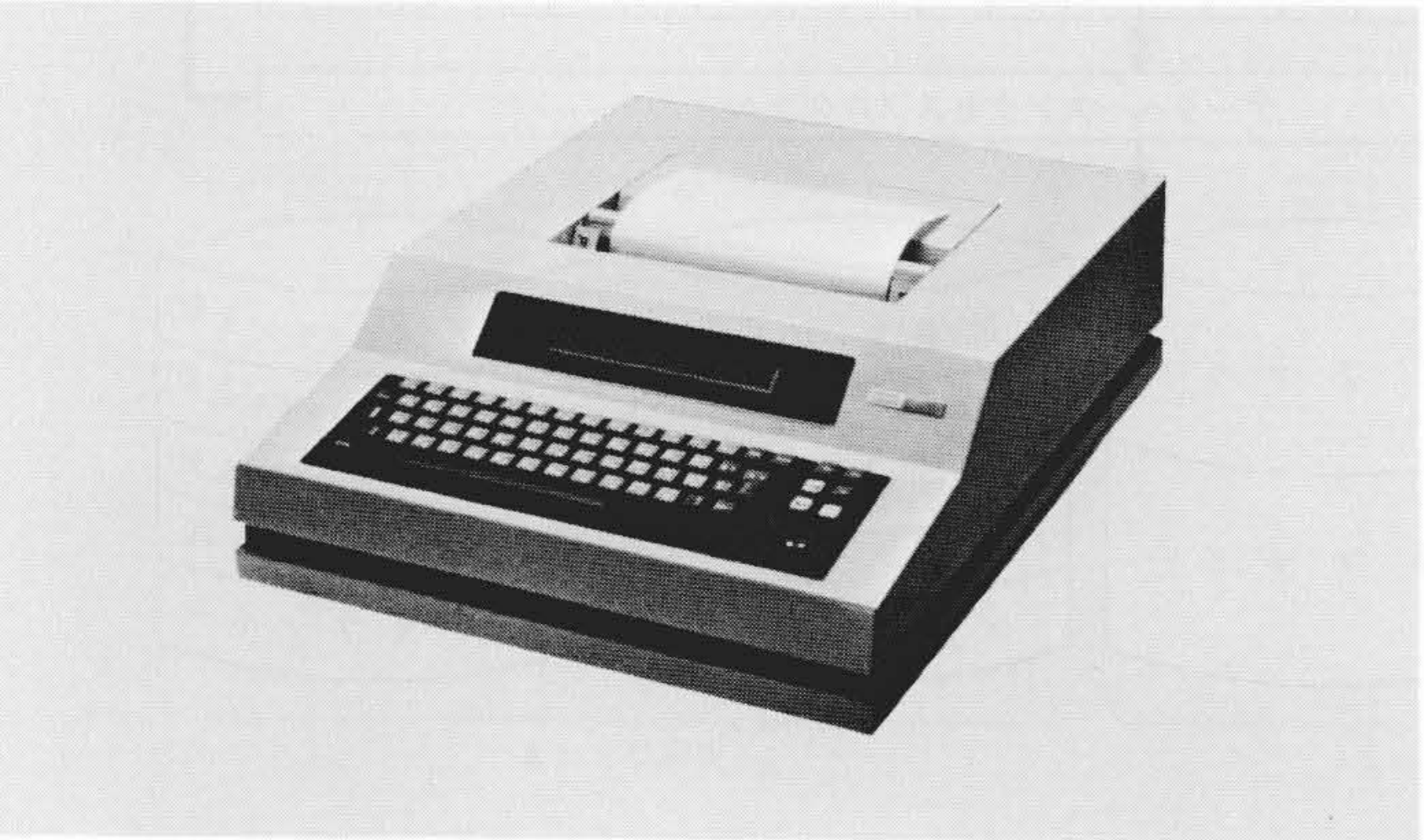
図5 HT-5217漢字プリンターミナルの外観 無制御手順で接続可能な小形、かつ軽量のターミナルである。
