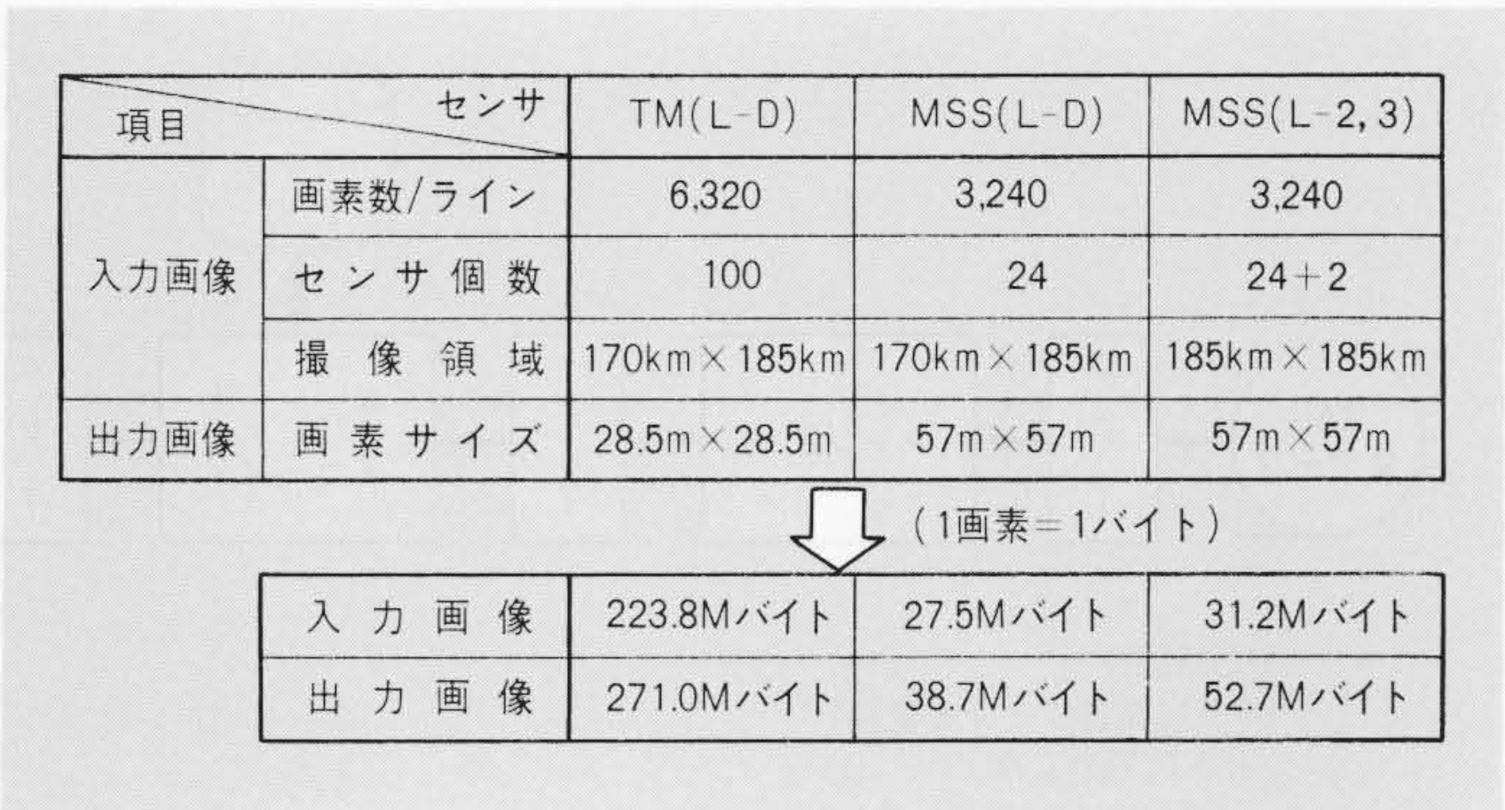
図5 「ランドサット3号」と「ランドサットD号」のデータ量比較 「ランドサットD号」のTMでは、入力画像で「ランドサット3号」の7倍、出力画像で5倍である。
