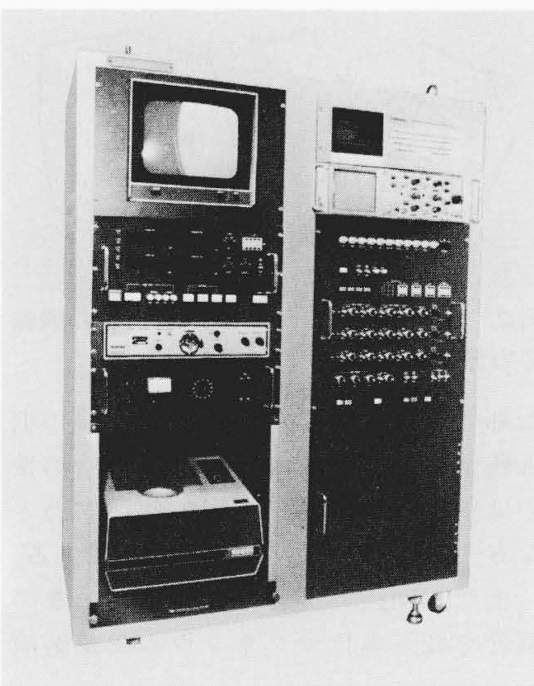
図1 ディジタル方式超音波ホログラフィー装置
