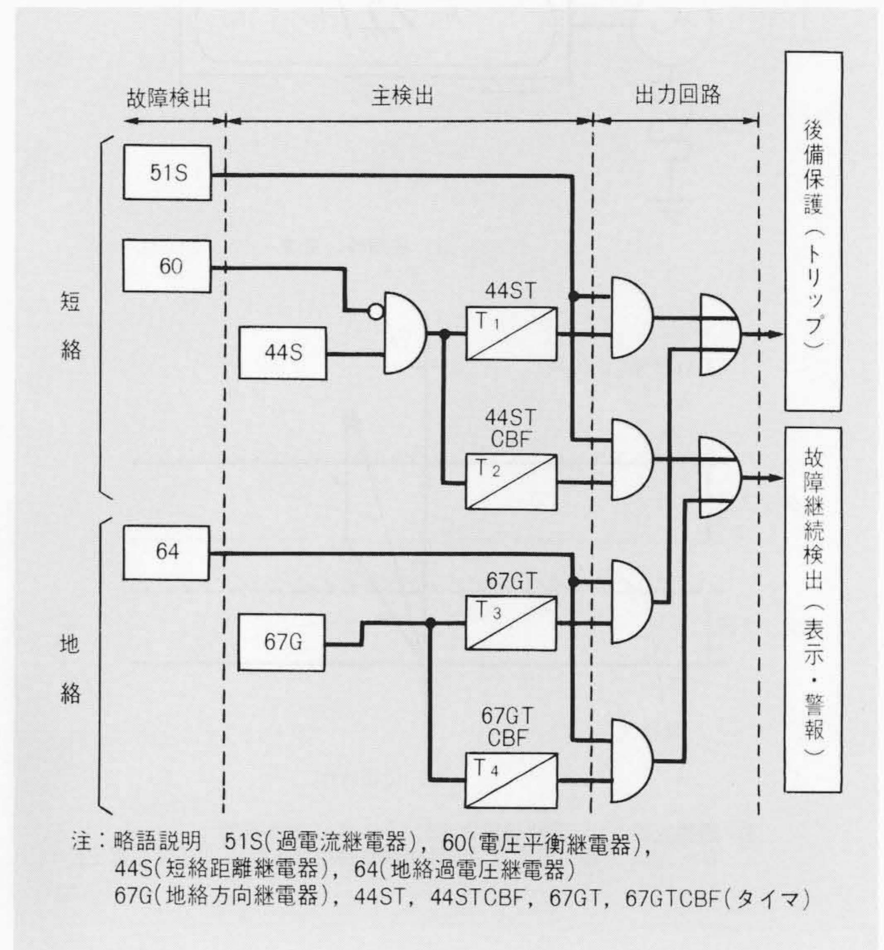
図5 保護方式シーケンスブロック 故障検出出力と主検出出力とを出力回路のハードウェアでアンドすることにより、システム信頼性を向上させた。
