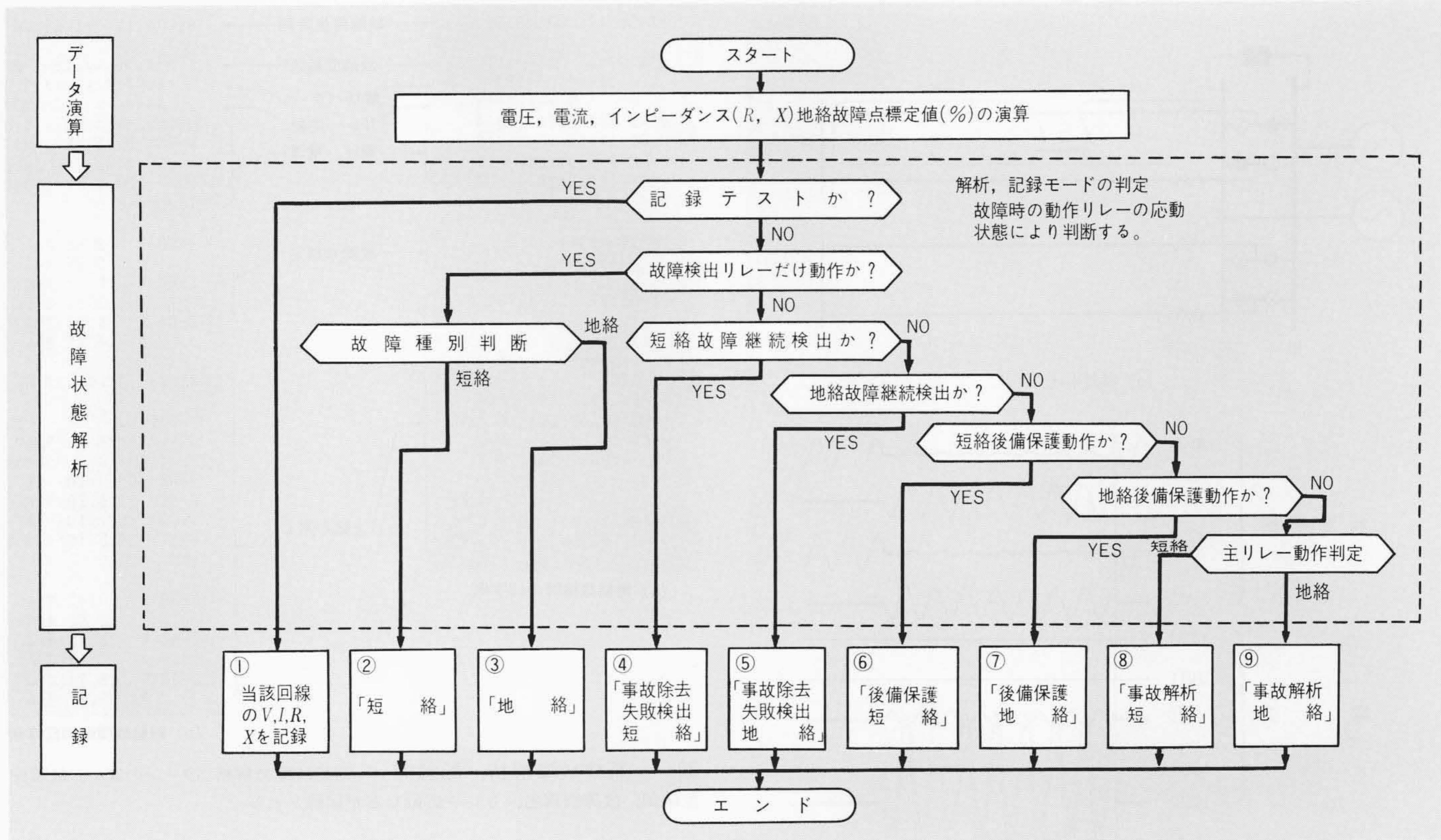
図8 系統故障状態の解析及び記録
