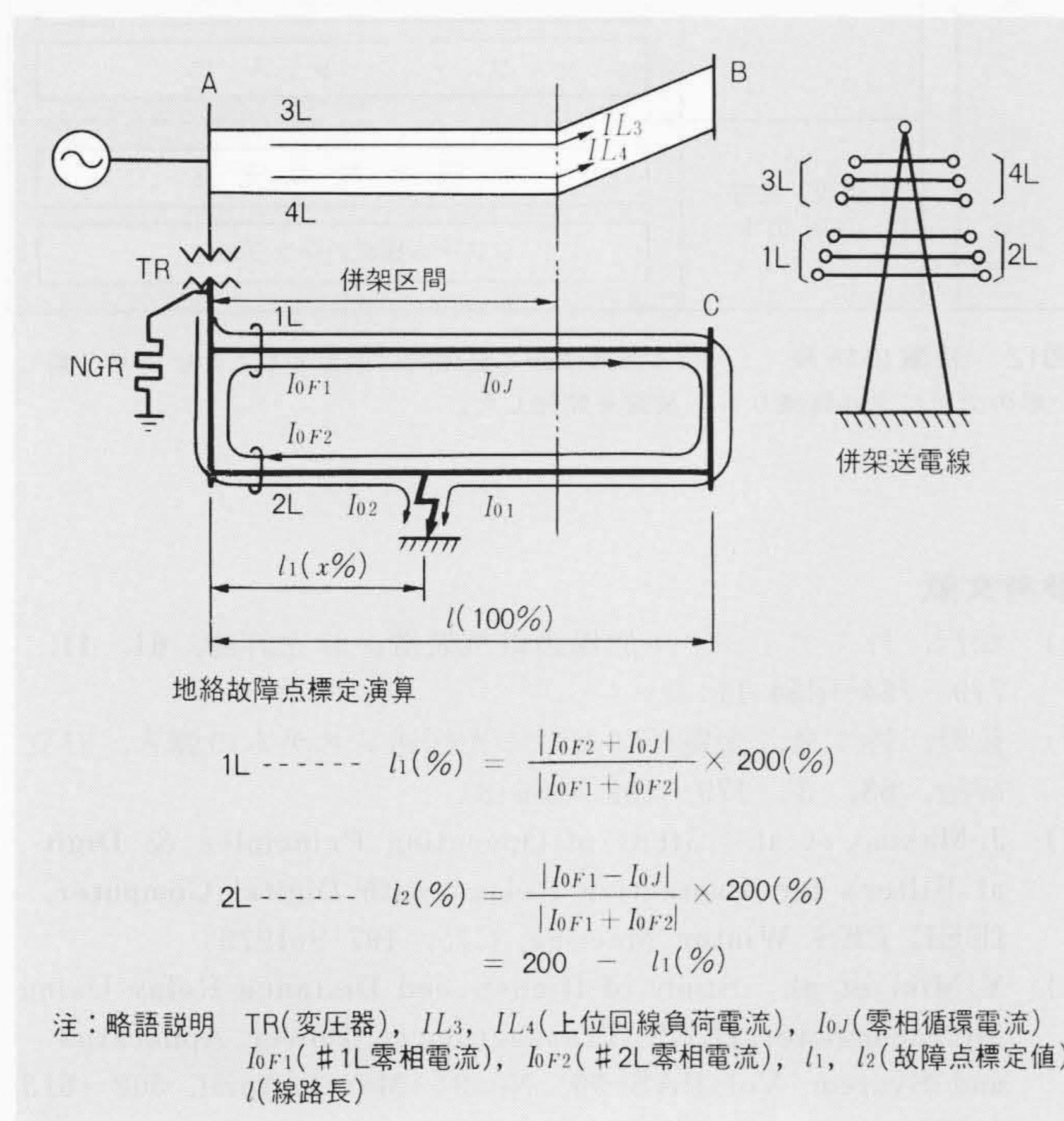
図9 地絡故障点標定 地絡故障電流の分流比により、故障点までの距離を送電線亘長に対する百分率で求める方式とした。
