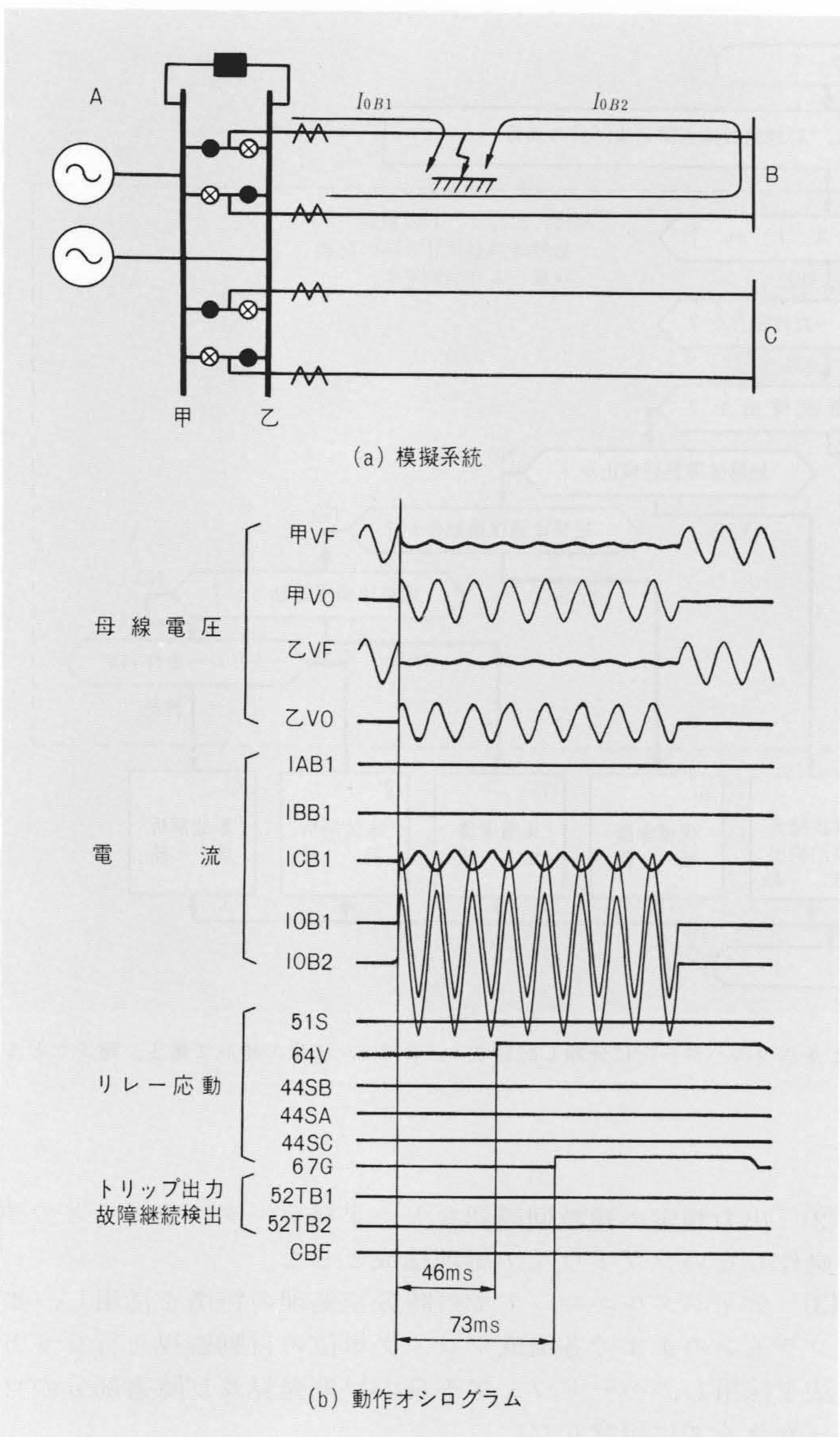
図10 工場試験結果のオシログラム例
