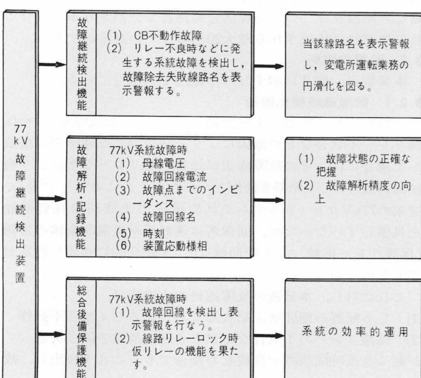
図2 装置の機能 本装置は図に示す三つの機能を統合化し、変電所運転業務の円滑化を目的とした。
