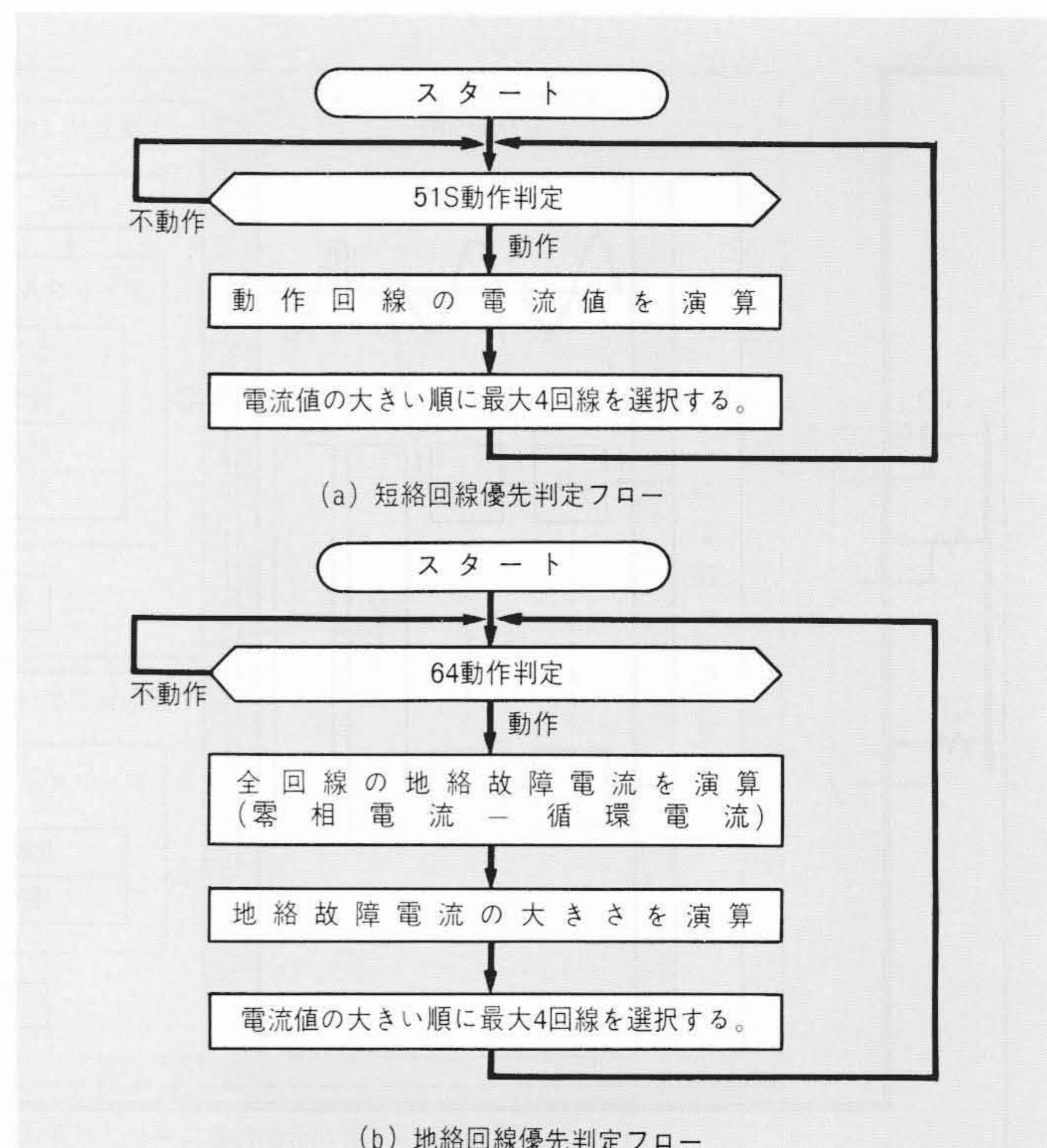
図7 故障回線の優先判定フロー 主検出部では最大4回線単位で多重故障を同時処理できるようにした。故障回線の選択は、短絡、地絡共故障電流の大きい順に4回線とする方式を採用した。
