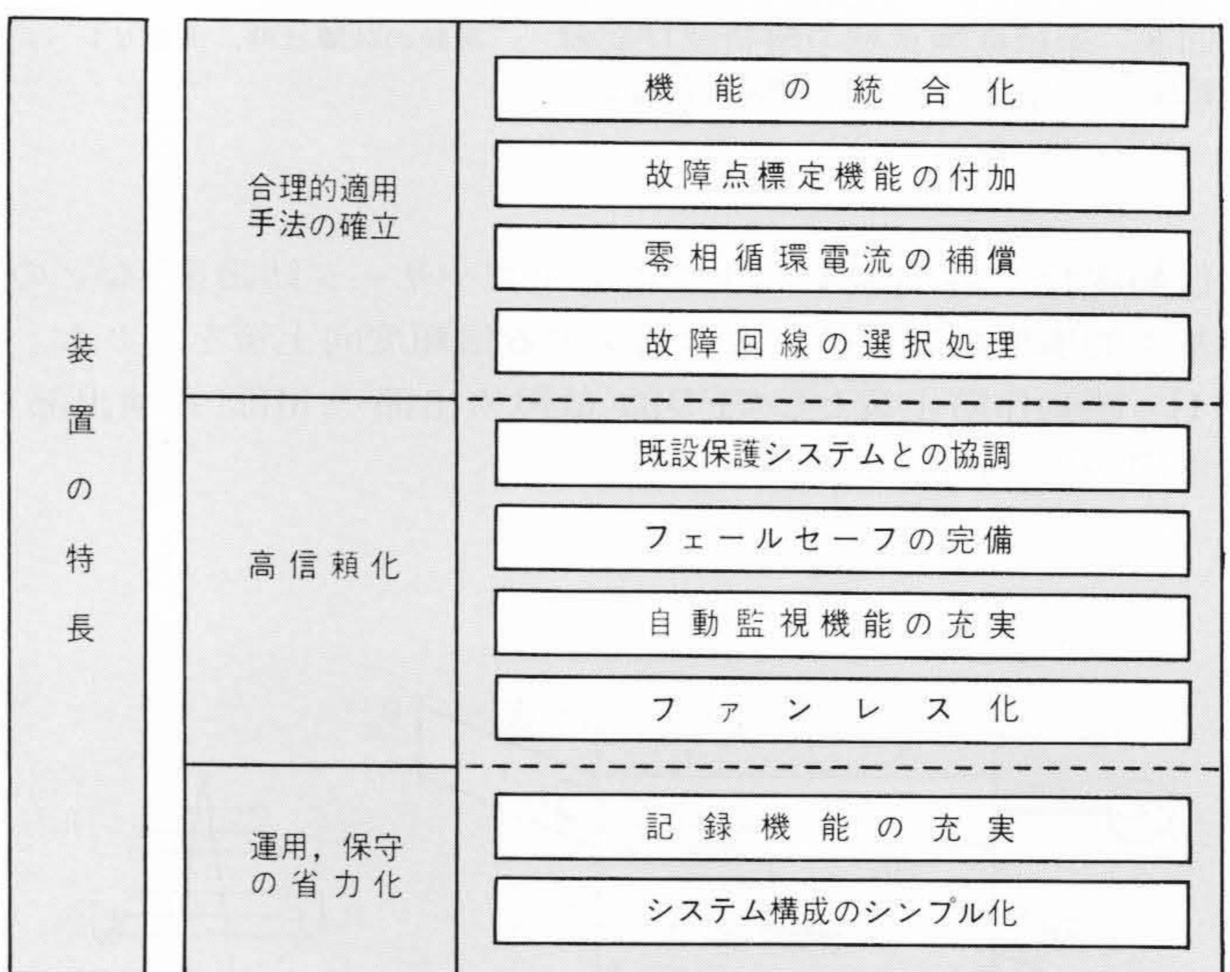
図12 装置の特長 ディジタル技術を合理的に活用することにより、新しい形のディジタル保護リレー装置を開発した。
