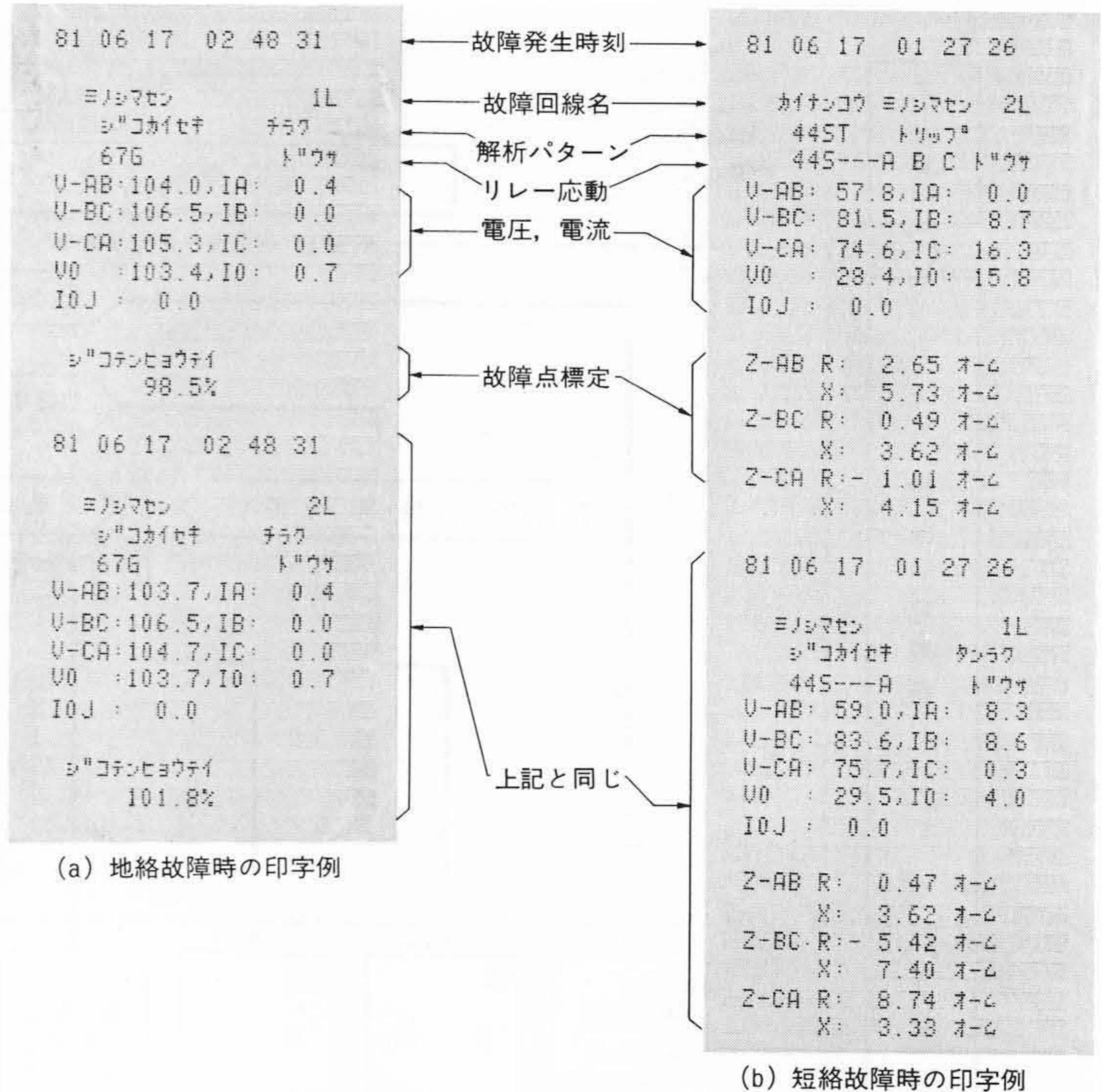
図11 系統故障解析、記録例 系統故障の解析パターンのほか、故障発生時刻、故障回線名、リレー応動などが記録される。
