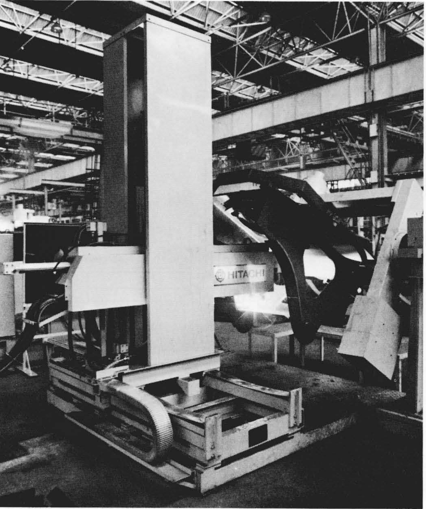
図3 「ミスターアロスSP」 ポジショナは、ワークを乗せて反時間方向に145度反転している。
